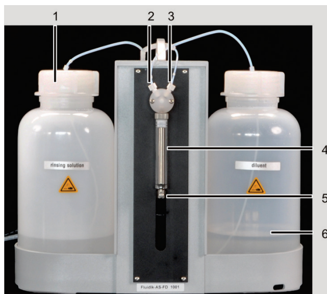
III. 53 Doseur sur le module fluidique de l'AS-FD
