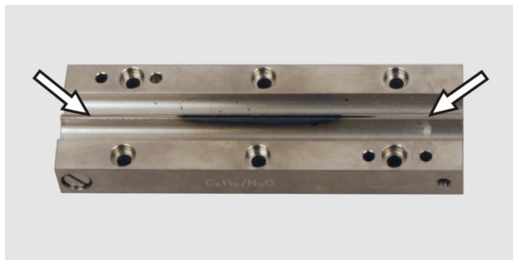
Рис. 65 Распорки, вставленные в щелки горелки
