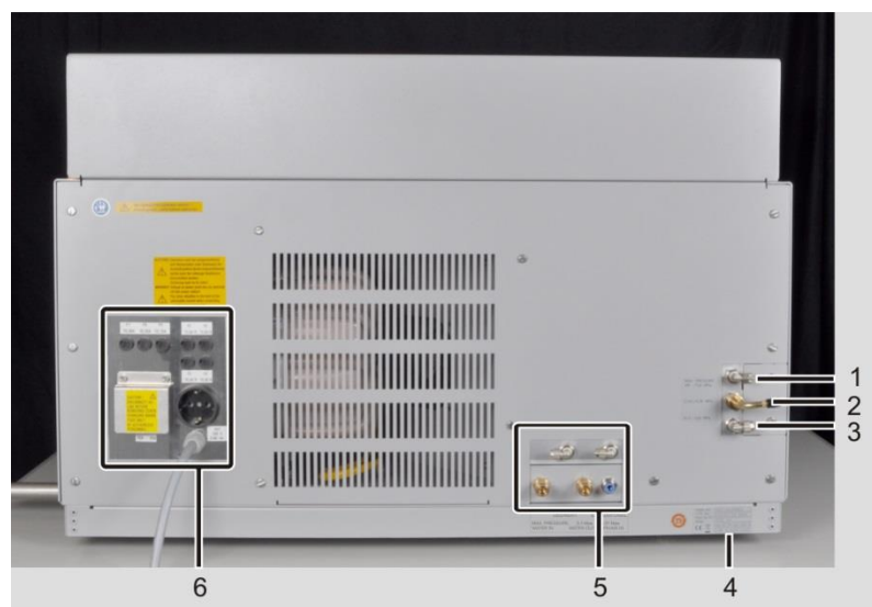
Рис. 26 Вид novAA 800 сзади с разъемами и предохранителями
