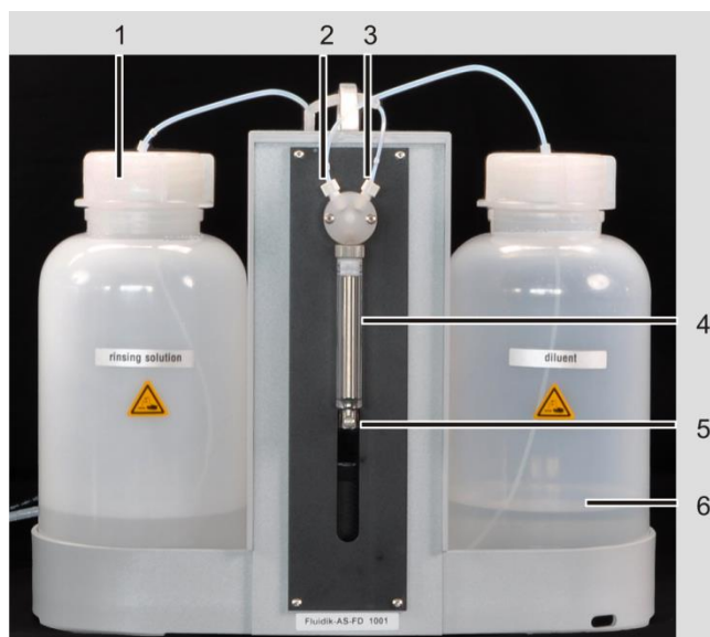
Рис. 53 Дозирующее устройство модуля Fluidics автосамплера AS-FD
