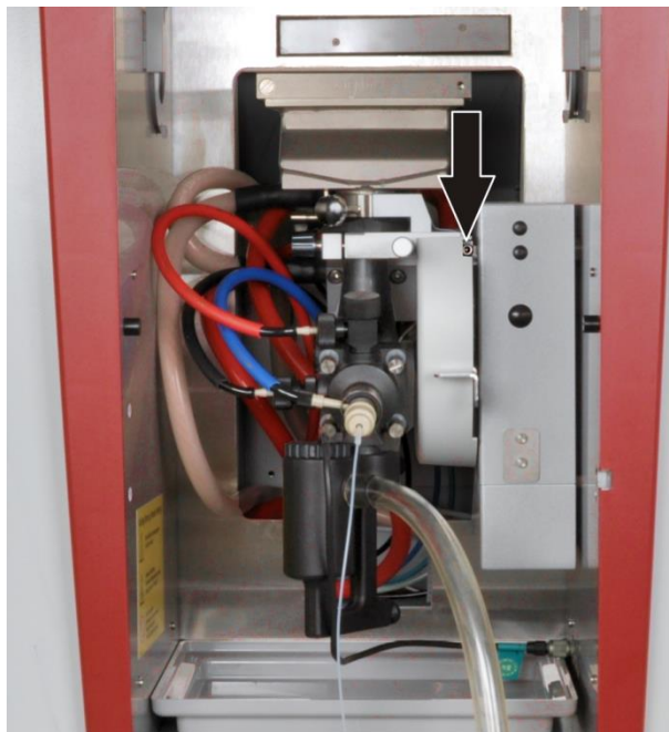
Рис. 67 Настроечный винт для выравнивания атолизатора
