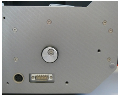
Abb. 33 Position der Excenterrolle am SSA 600
