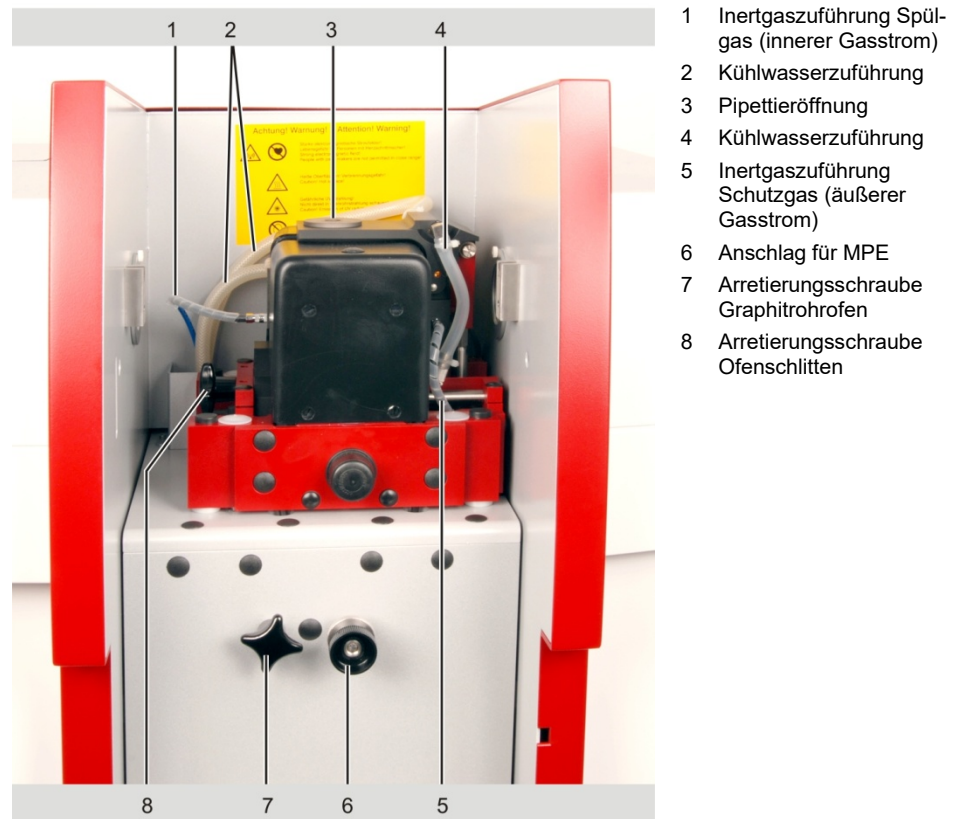
Abb. 37 Arretierungsschrauben Graphitrohrföfen
