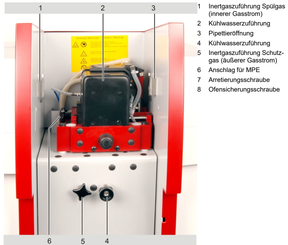
Abb. 8 Zeeman-Graphitrohrföfen
