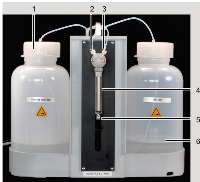
Imag. 42 Dosificador en el módulo de fluidica del AS-FD
