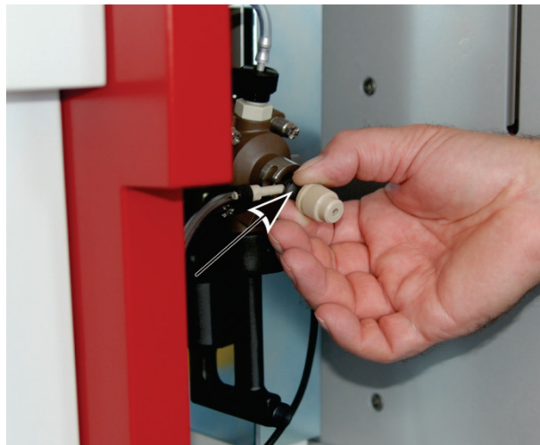
Imag. 60 Extracción del pulverizador de la cámara de mezclas
