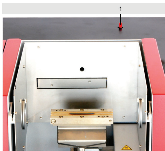
Imag. 25 Protección para el transporte en el ZEEnit 700 P
