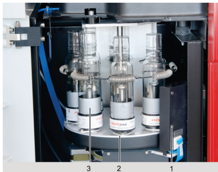
Imag. 18 Estructura del cambiador de lámparas
