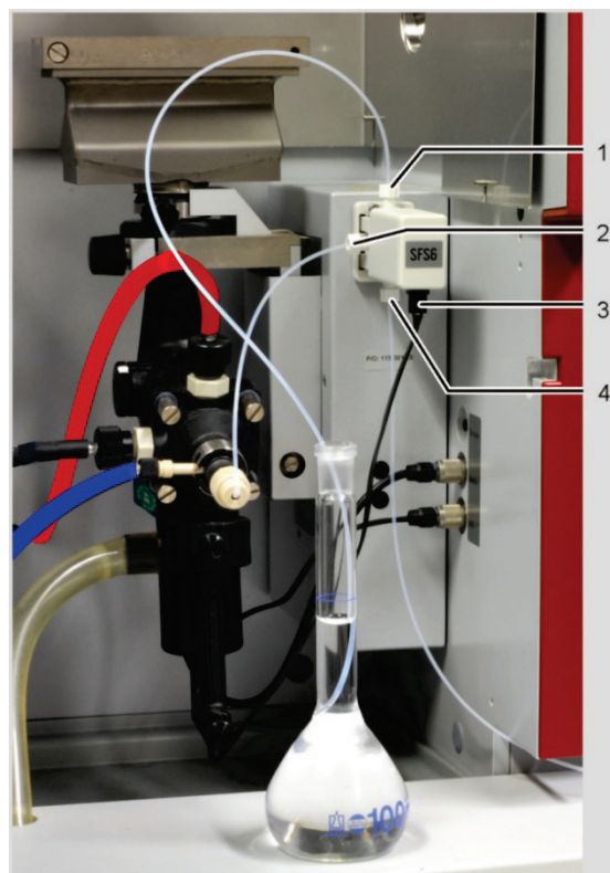
Imag. 43 SFS 6 instalado para la alimentación manual de muestras
