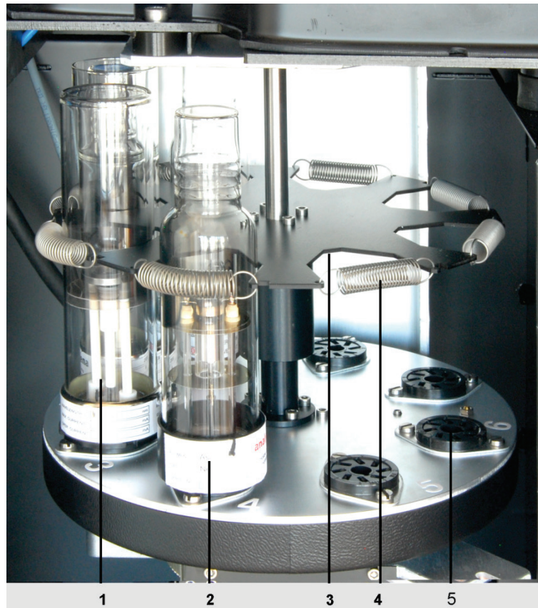
Imag. 26 Estructura del cambiador de lámparas
