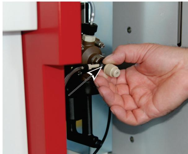
Fig. 60 Retrait du nébuliseur hors de la chambre de mélange
