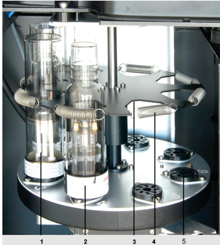
Fig. 26 Structure de la tourelle à lampes
