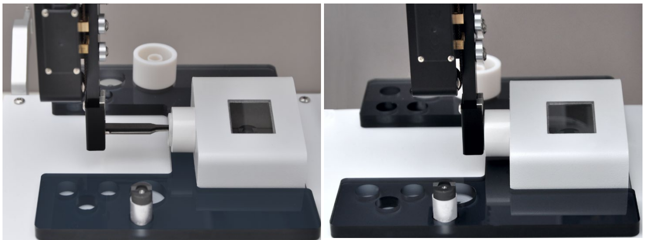
Imagen 5 Balanza con cubierta de protección contra el viento y esclusa de muestras
