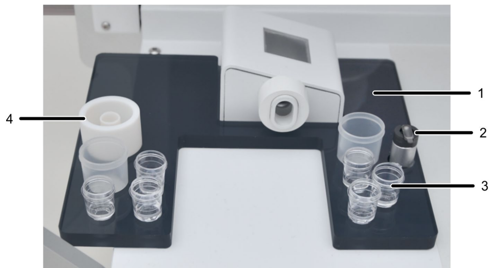
Imagen 6 Soporte de muestras para dosificador líquido
