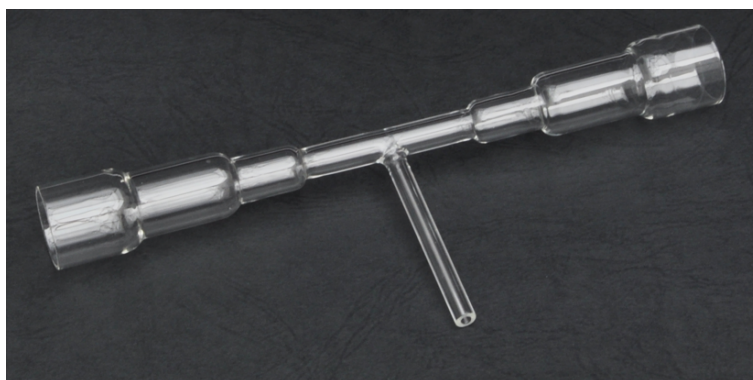
Fig. 8 Cubeta Hg (hecha de cuarzo, con forma de tulipán)
