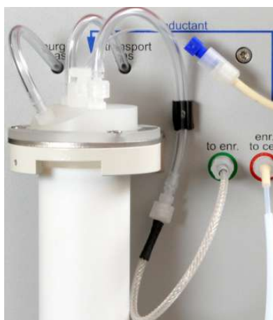
Fig. 15 Tubería para modo de funcionamiento "Hg sin enriquecimiento"
