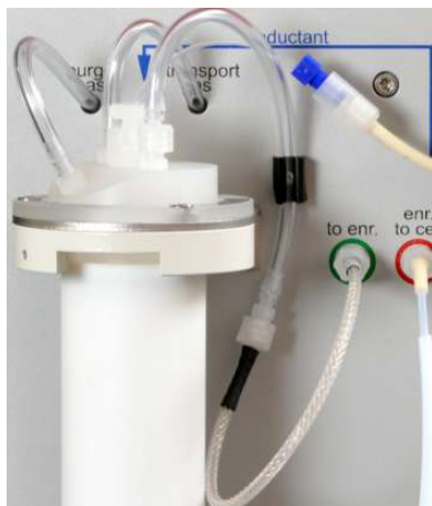
Fig. 17 Tubería para modo de funcionamiento "Hg sin enriquecimiento"
