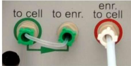
Fig. 20 Tubería para modo de funcionamiento "Hg sin enriquecimiento"
