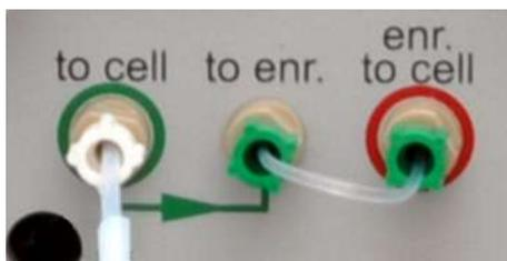
**Fig. 17 Tubería para modo de funcionamiento "Hidruro"/"Hg sin enriquecimiento"**
