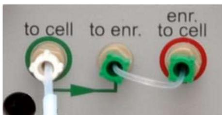
**Fig. 19** Tubería para modo de funcionamiento "Hidruro"/"Hg sin enriquecimiento"
