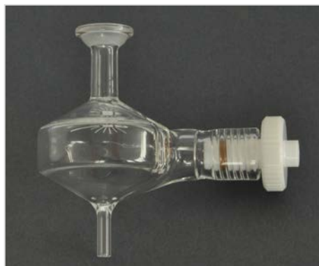
Fig. 2 Chambre de nébulisation cyclonique 20 mL
