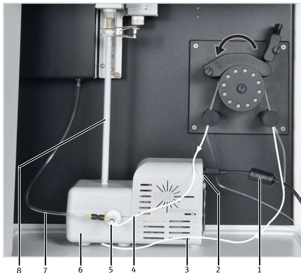
Fig. 25 Instalación de la cámara de pulverización con control de temperatura
