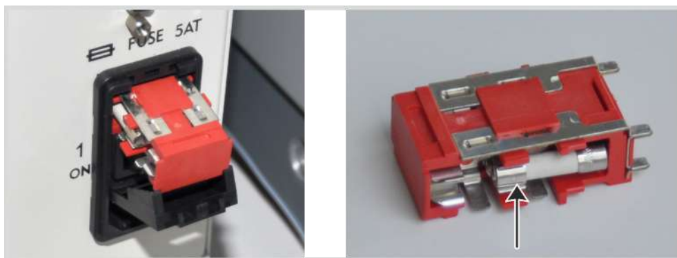
Fig. 36 Sustitución de fusibles en el automuestreador
