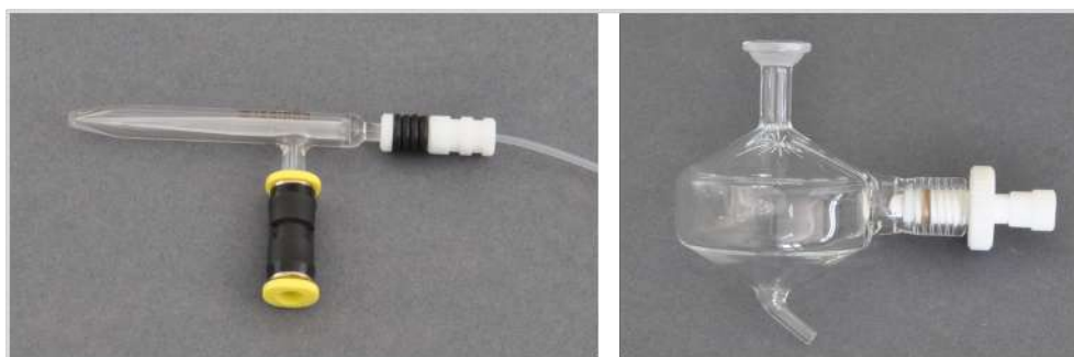
Fig. 5 Nébuliseur concentrique et chambre de nébulisation
