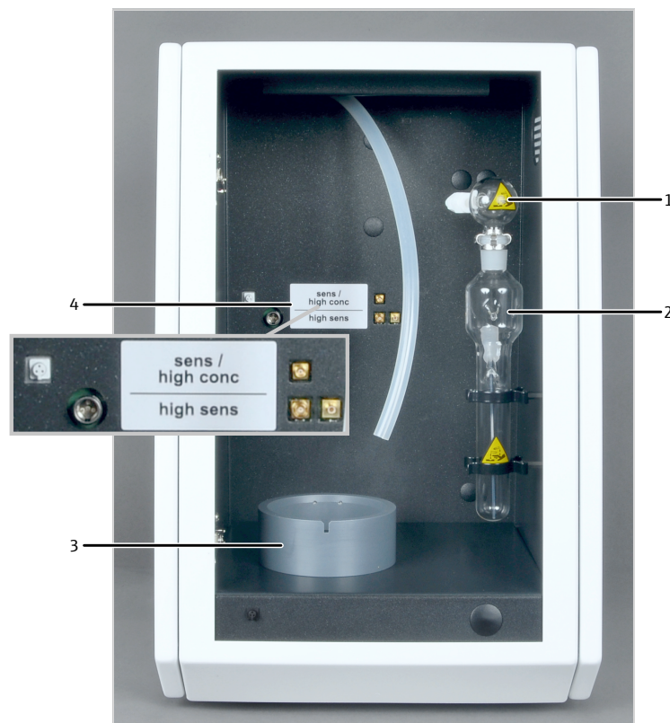
Fig. 25 Estructura del detector de cloro (sin célula de medición)
