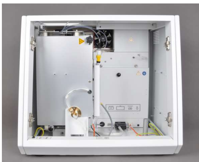
Fig. 15 Horno de combustión en modo de funcionamiento vertical y horizontal
