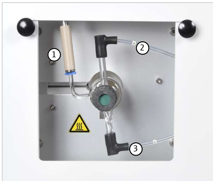
Fig. 14 Conexiones en el tubo de combustión
