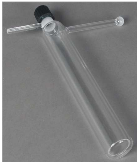
Fig. 58 Tubo de combustión TOC (sin relleno)
