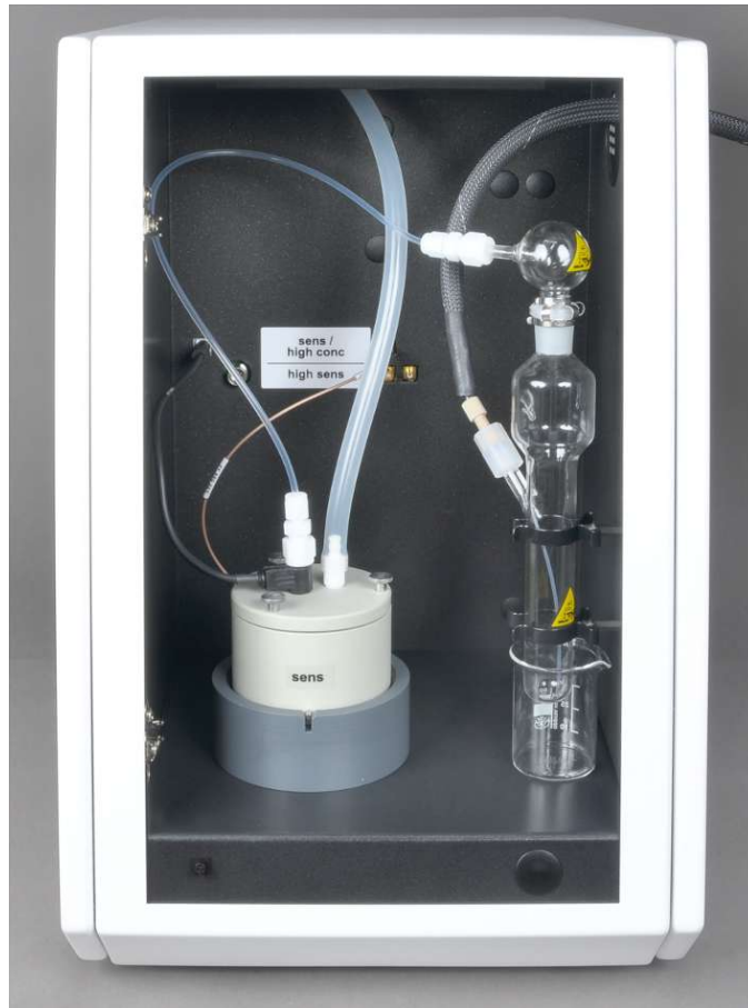
Fig. 40 La introducción de gas en la célula de medición "sensitive"
