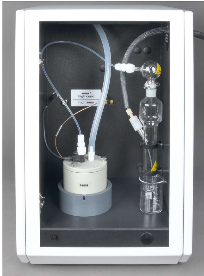
Fig. 40 Arrivée du gaz dans la cellule de mesure "sensitive"
