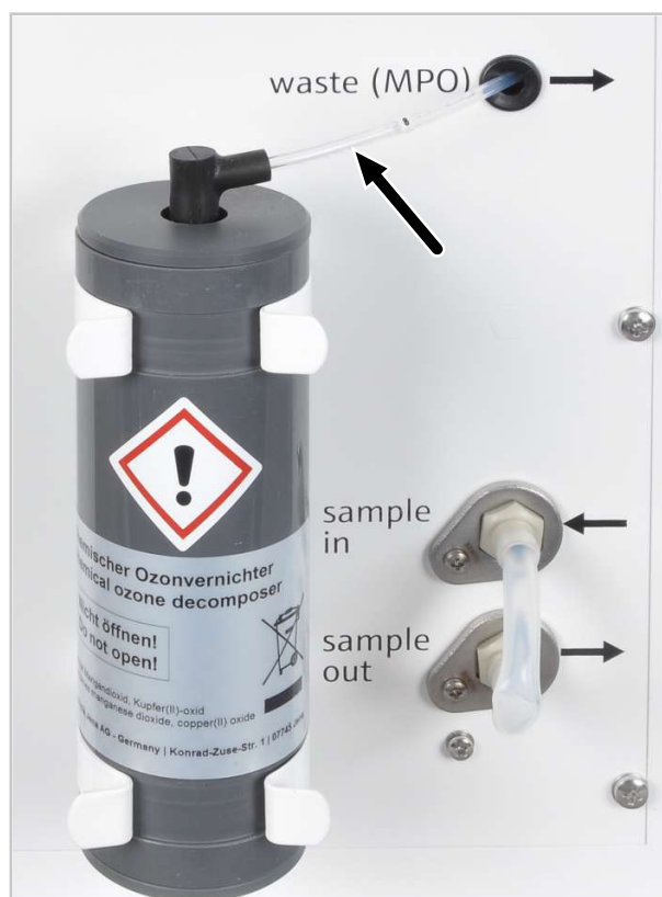
Fig. 45 Destructeur chimique d'ozone
