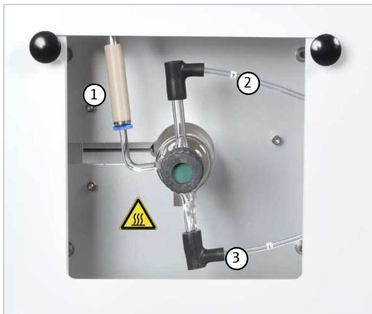
Fig. 14 Raccords sur le tube de combustion
