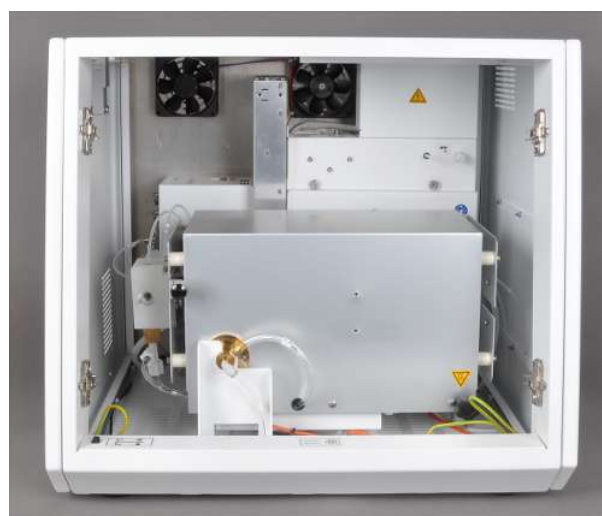
Изобр. 15 Печь для сжигания в вертикальном и горизонтальном режимах работы
