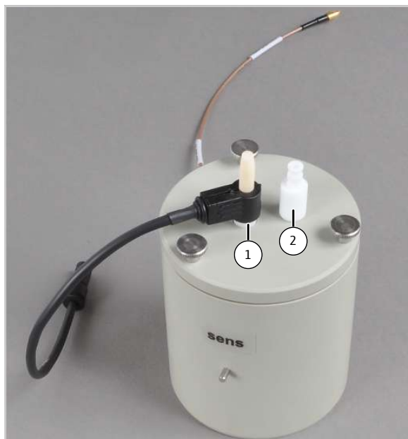
Изобр. 27 Собранная измерительная ячейка
