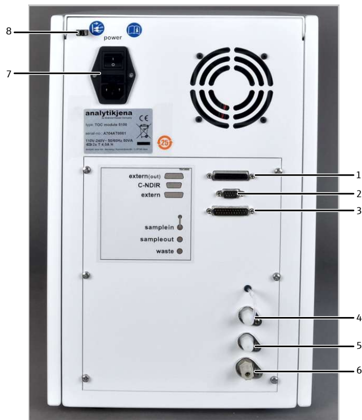
Изобр. 62 Задняя панель детектора TOC
