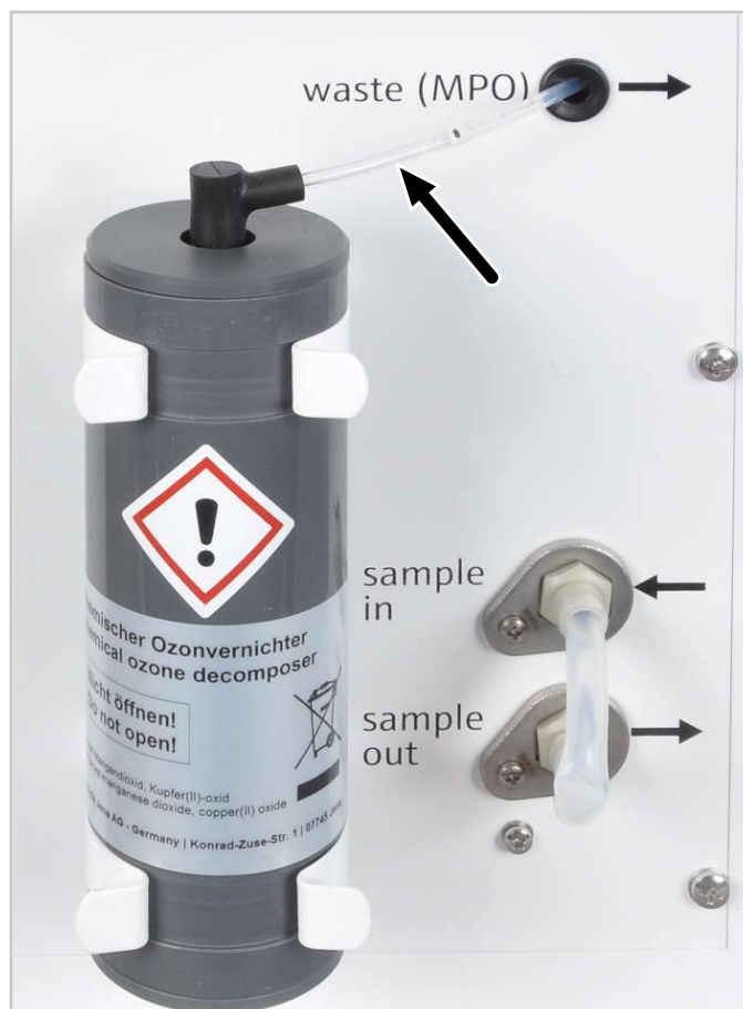
Изобр. 73 Замена химического деозонатора
