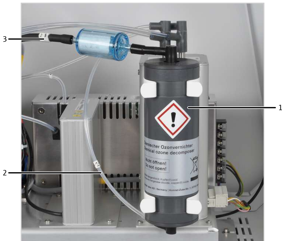
Изобр. 70 Замена химического деозонатора
