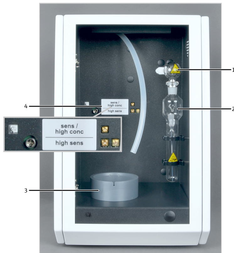
Abb. 25 Aufbau des Chlordetektors (ohne Messzelle)
