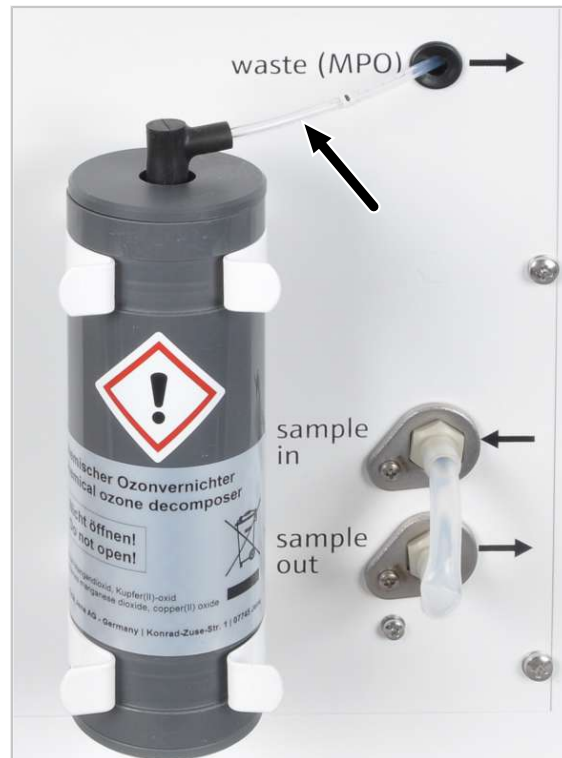
Abb. 73 Chemischen Ozonvernichter wechseln
