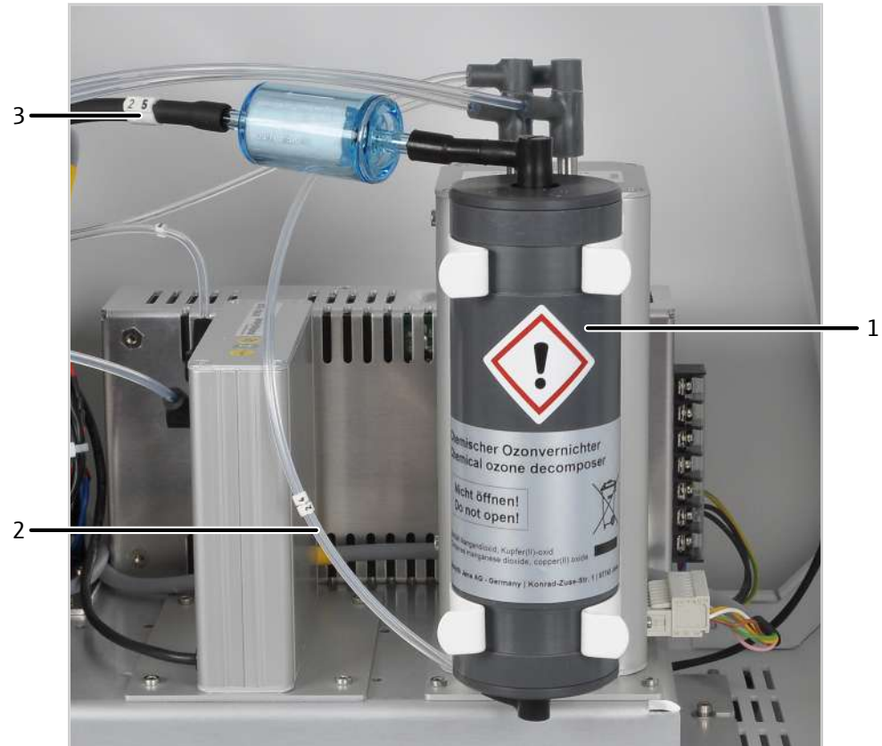
Abb. 70 Chemischen Ozonvernichter wechseln
