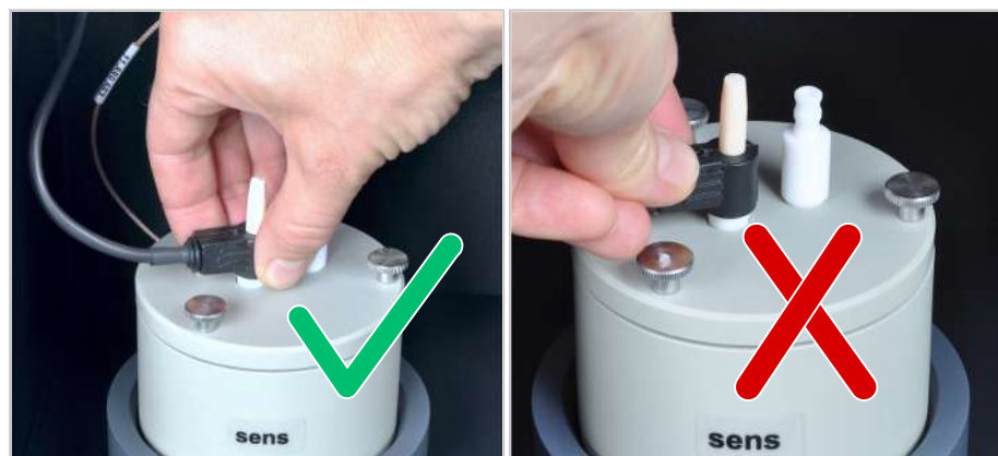
Abb. 72 Kombielektrode richtig handhaben
