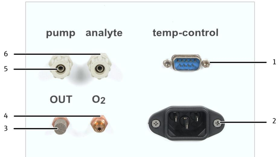
**Fig. 15 Conexiones en el panel trasero del módulo de materia sólida**
