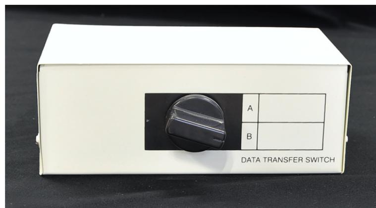
Fig. 24 Cambio de la switch box serial
