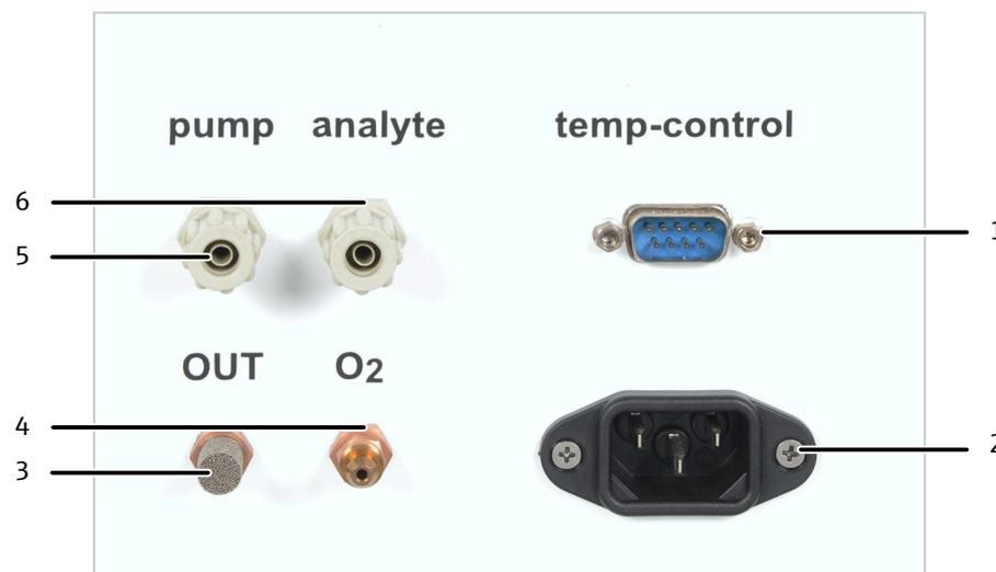
**Fig. 4 Conexiones en el panel trasero del módulo de materia sólida**
