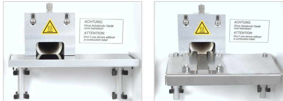
**Fig. 14** Mesa de muestras para la introducción manual y automática de las muestras
