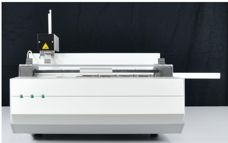
**Fig. 9 Automuestreador de sólidos FPG 48**
