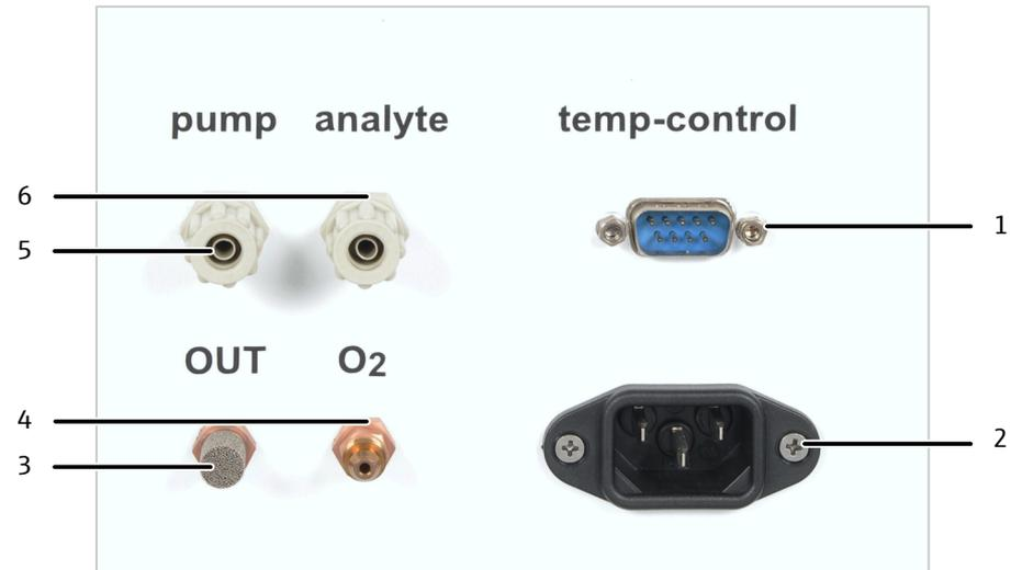
Abb. 15 Anschlüsse an der Rückwand des Feststoffmoduls
