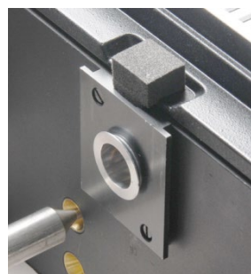
Abb. 103 Reflektor in die Aufnahme für Küvettenhalter eingesetzt
