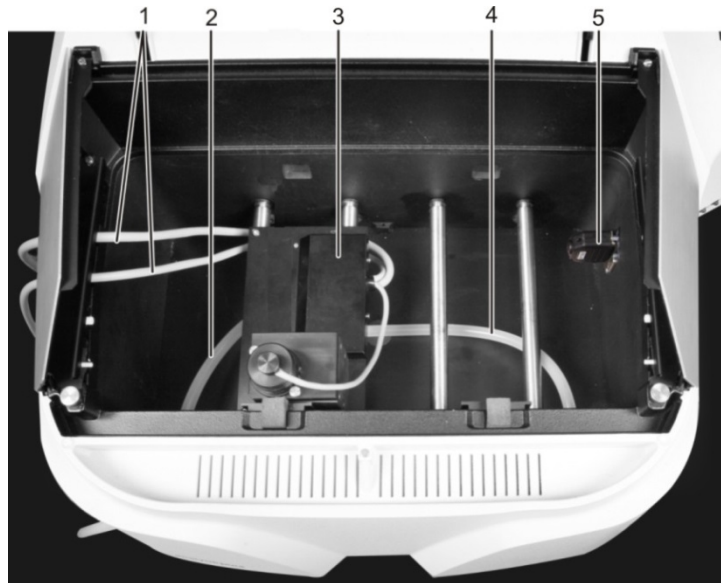
Abb. 56 Peltiertempериertes Küvettenhalter im SPECORD PLUS installiert
