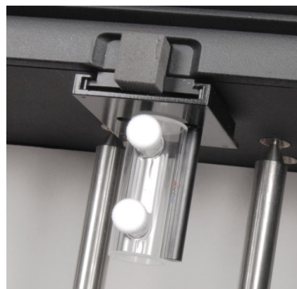
Abb. 25 Halter für Zylinderküvetten im SPECORD PLUS montiert
