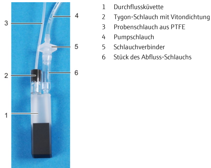
Abb. 70 Durchflussküvette mit angeschlossenen Probenschlauch und Pumpschlauch
