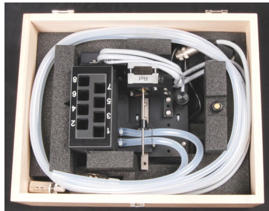
Abb. 61 Peltiertemperierter 8fach-Küvettenwechsler in Aufbewahrungsbehälter
