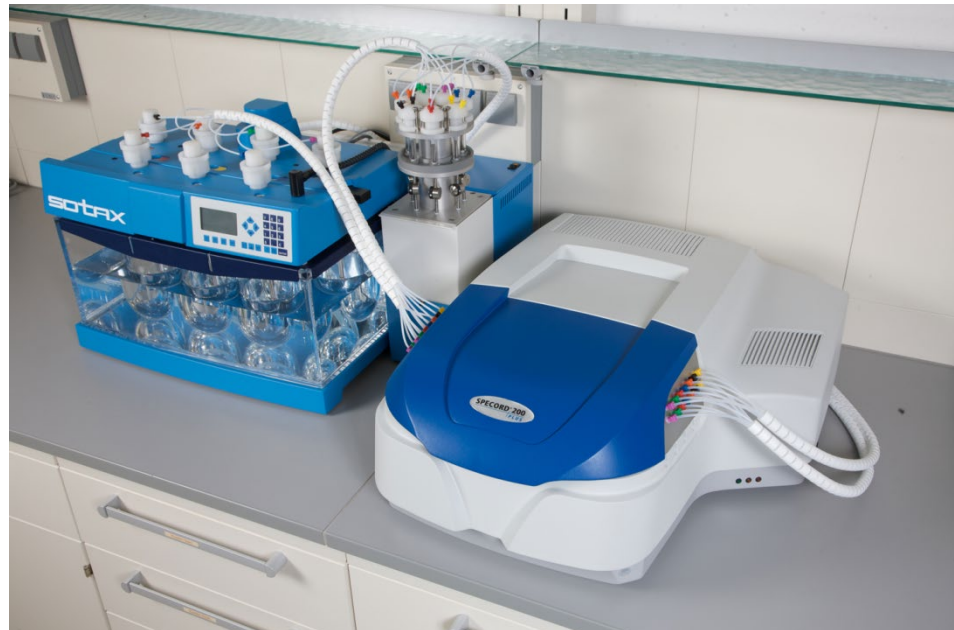
Abb. 86 SPECORD PLUS mit angeschlossenem Dissolution-System
