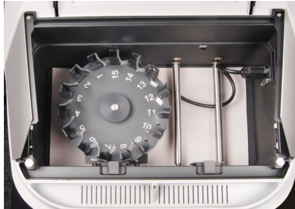
Abb. 39 Küvettenkarussell fertig montiert
