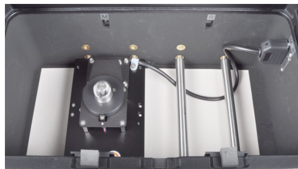
Abb. 38 Grundplatte des Küvettenkarussells im SPECORD PLUS montiert
