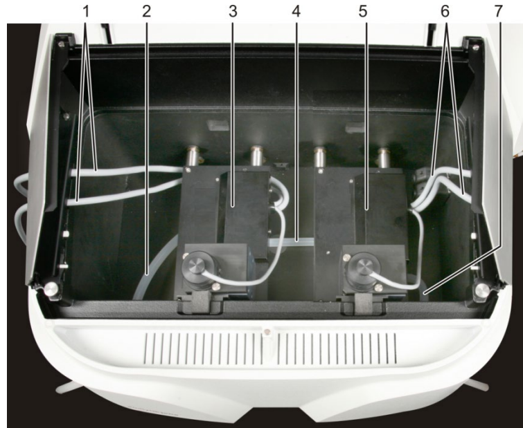
Abb. 57 Zwei Küvettenhalter (peltiertemp. mit Wärmetauscher) im Probenraum montiert
