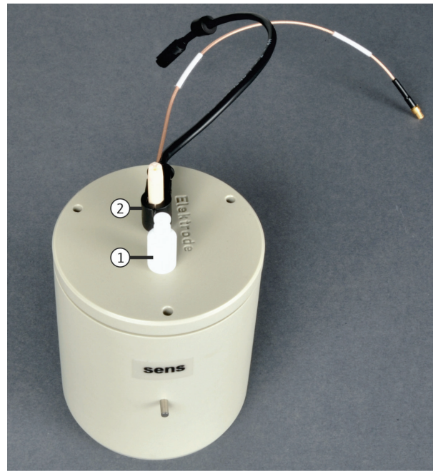
Abb. 22 Messzelle "sensitive" bestückt
