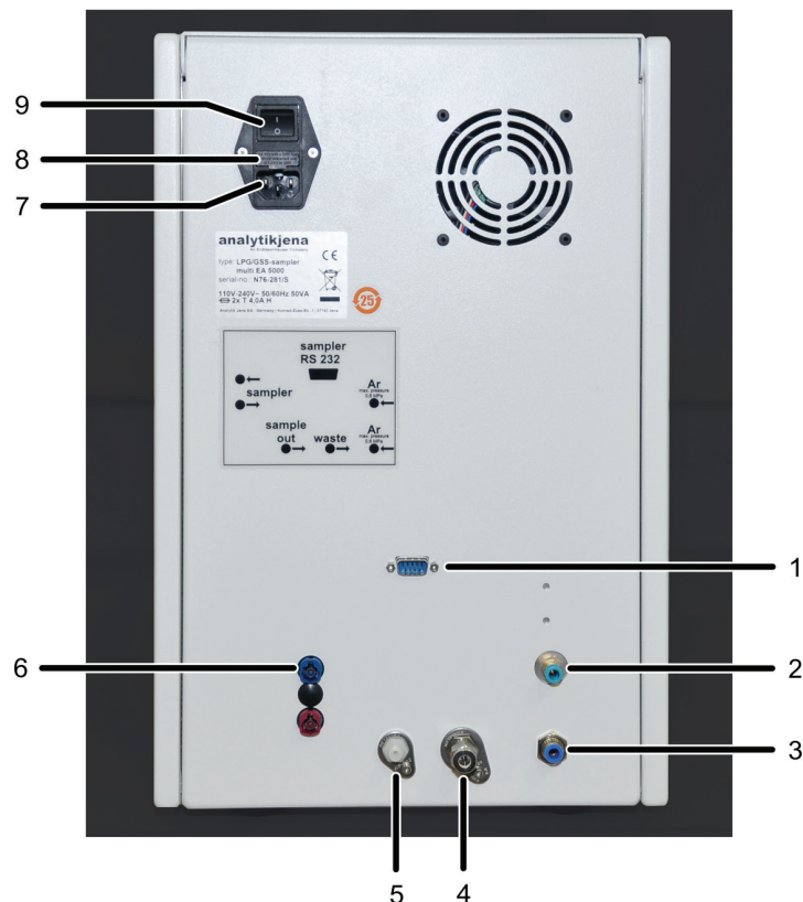
Bild 7 Geräterückseite des GSS/LPG Kombimoduls mit Schnittstellen und Geräteschalter
