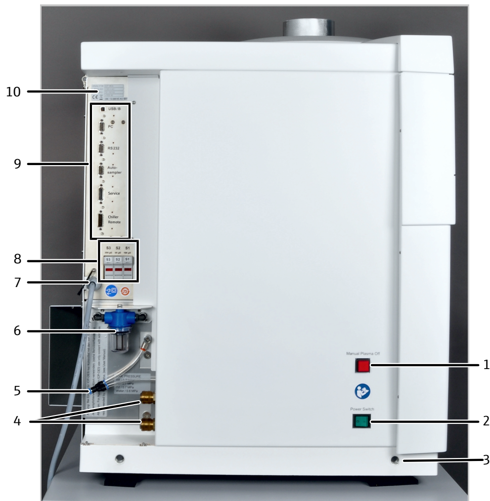
Изобр. 6 Разъемы на левой стороне устройства
