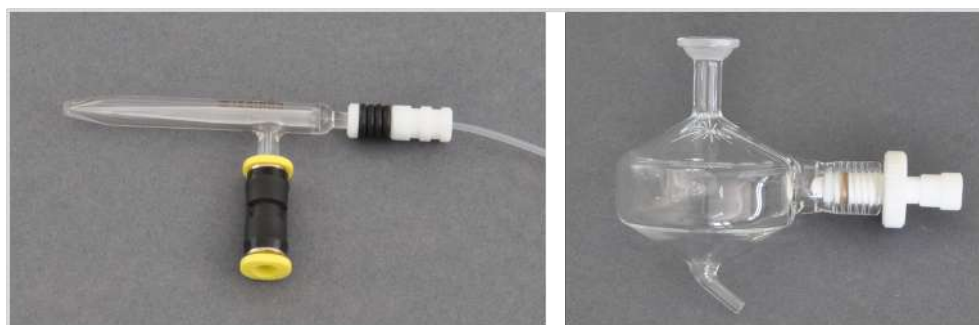
Изобр. 5 Концентрический распылитель и распылительная камера
