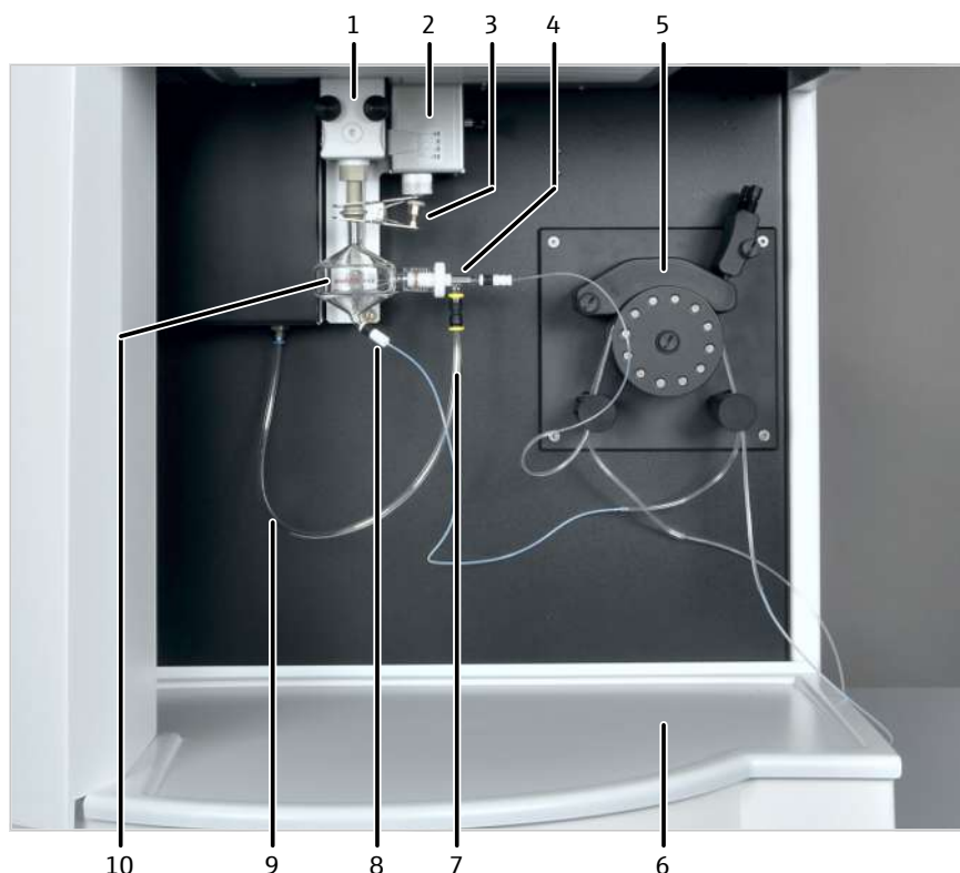
Изобр. 12 Отсек подачи проб
