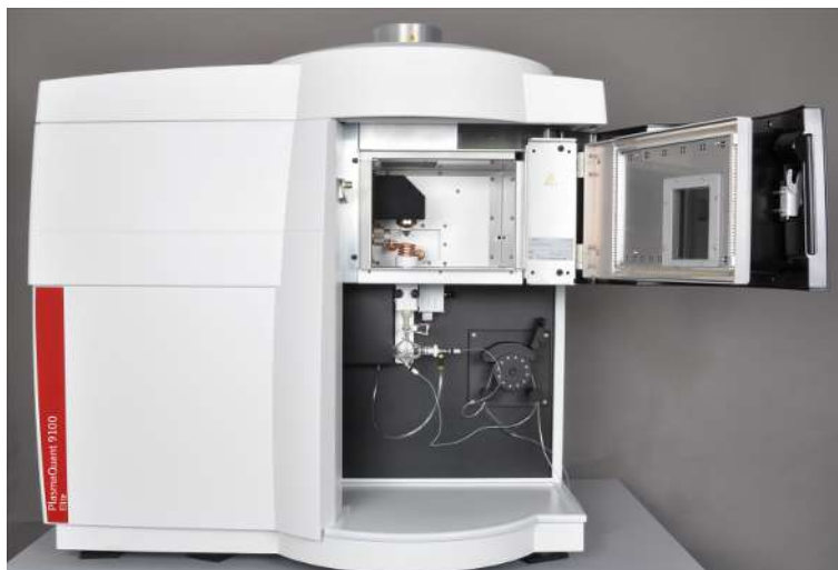
Изобр. 1 Эмиссионный спектрометр с открытым отсеком плазмы
