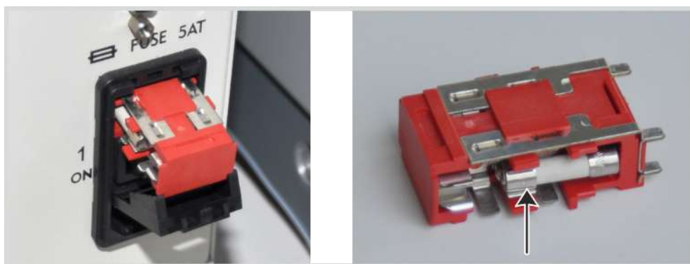
Изобр. 36 Замена предохранителей в автосамплере
