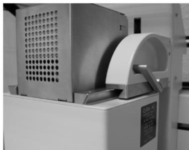
Abb. 20: Pipettierkopf aufschieben
