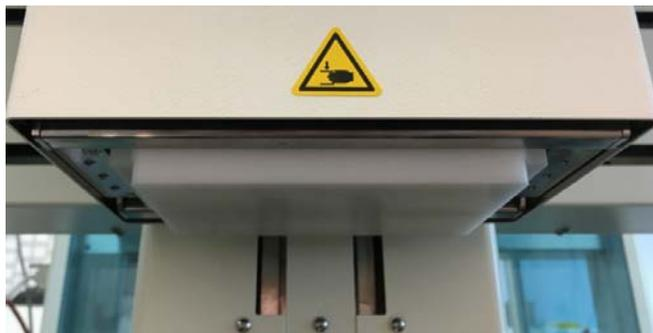
Abb. 46: Schutzmagazin (Transportsicherung) aufgenommen
