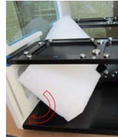
4. Transportsicherung der Kopfaufnahme einsetzen.
