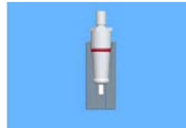
2. Falls dieser Versuch des O-Ring Entfernens nicht erfolgreich war, gibt es noch eine alternative Lösung für das Entfernen des O-Rings. Dazu drehen Sie das O-Ring Montagewerkzeug um. Hier befindet sich eine Spitze (an der Seite des O-Ringführungsstiftes), die ebenfalls zum Entfernen des O-Rings genutzt werden kann. Dazu drücken Sie die Spitze gegen den O-Ring und entfernen diesen anschließend.
