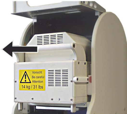
Abb. 111: Pipettierkopf herausziehen (Ausführung: Kopfwechsel von hinten)
