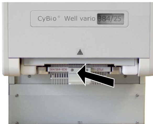
Abb. 116: Spitzenmagazin einschieben (Ausführung: Kopfwechsel von hinten)
