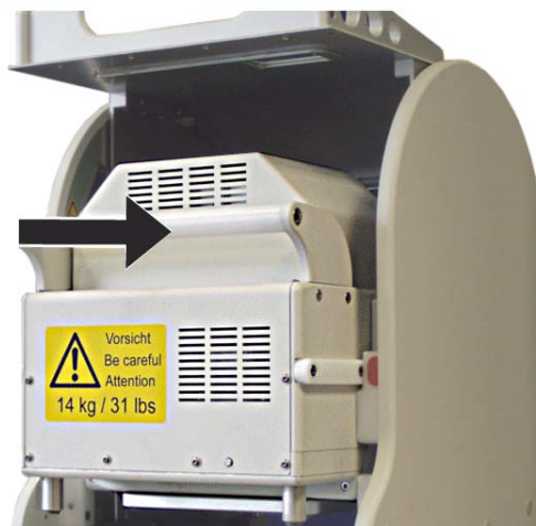
Abb. 112: Pipettierkopf einschieben (Ausführung: Kopfwechsel von hinten)
