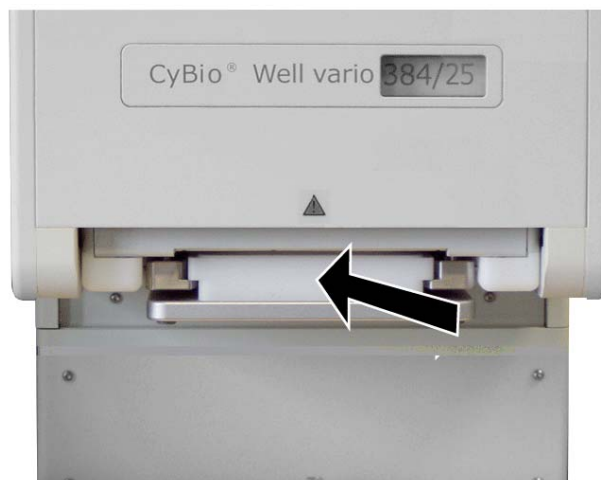
Abb. 107: Magazinadapter einsetzen (Ausführung: Kopfwechsel von hinten)
