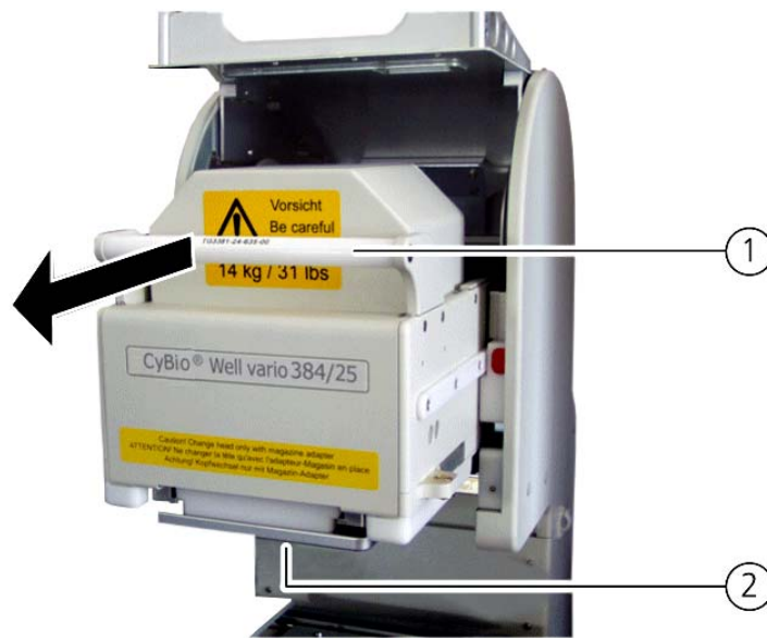
Abb. 97: Pipettierkopf herausziehen (Ausführung: Kopfwechsel von vorn)
