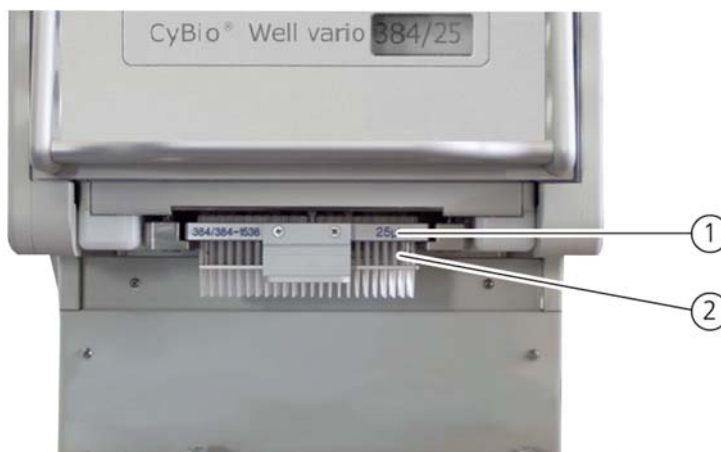
Abb. 65: Spitzenmagazin wechseln (Ausführung: Kopfwechsel von vorn)
