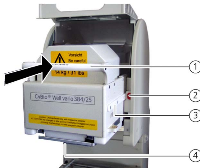
Abb. 98: Pipettierkopf einschieben (Ausführung: Kopfwechsel von vorn)
