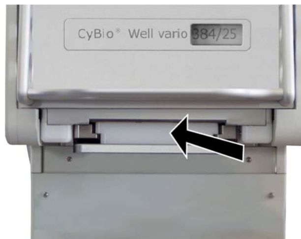
Abb. 93: Magazinadapter einsetzen (Ausführung: Kopfwechsel von vorn)
