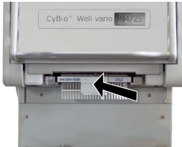
Abb. 102: Spitzenmagazin einschieben (Ausführung: Kopfwechsel von vorn)
