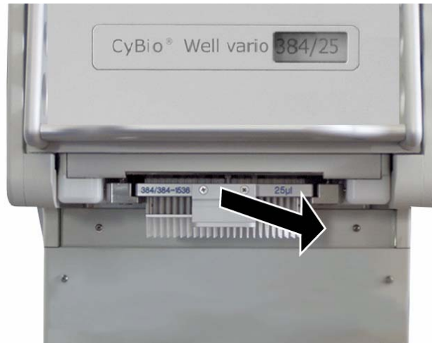
Abb. 91: Spitzenmagazin oder Kapillarmagazin entfernen (Ausführung: Kopfwechsel von vorn)
