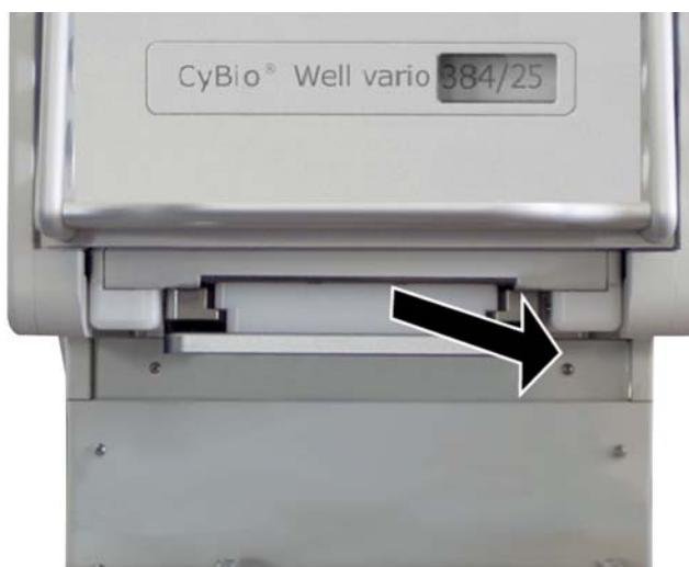
Abb. 100: Magazinadapter entfernen (Ausführung: Kopfwechsel von vorn)
