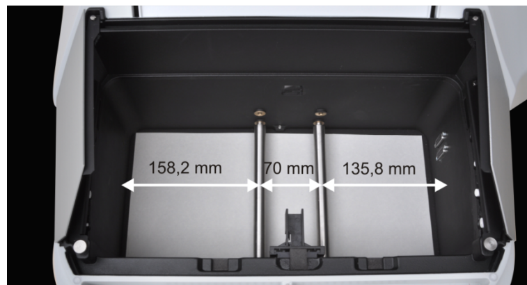
Fig. 10 Dimensions du compartiment d'échantillon du SPECORD 50 PLUS
