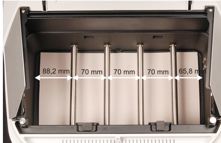
Fig. 8 Dimensions du compartiment d'échantillon du SPECORD 200/210/250 PLUS
