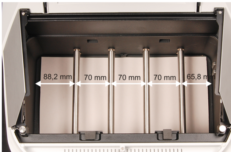
Fig. 8 Medidas del compartimento de muestras SPECORD 200/210/250 PLUS
