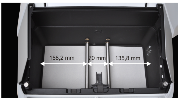
Fig. 10 Medidas del compartimento de muestras SPECORD 50 PLUS
