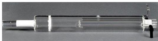
10. Осмотреть трубку для сжигания на чрезмерную кристаллизацию, наличие трещин и сколов. Использовать повторно только исправные трубки для сжигания без дефектов.
