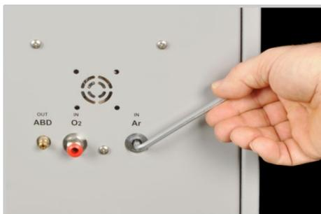
6. Выкрутить расположенный внутри пылевой фильтр с помощью ключа-шестигранника на 5 мм.
