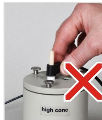
Не тяните и не расшатывайте боковую гнездовую часть электрического соединения. Иначе соединения в гнездовой части будут повреждены (их не видно снаружи)!
