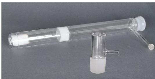
10. Проверить трубку для сжигания на чрезмерную кристаллизацию, наличие трещин и сколов. Использовать повторно только исправные трубки для сжигания без дефектов.
