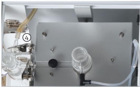
6. Через адаптер со сферическим шлифом подключить трубку анализируемого газа (4) к сосуду для серной кислоты. Зафиксировать соединение вильчатым зажимом.
