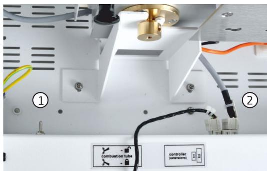
5. Открыть пневматическое уплотнение на блоке автоматической защиты. Для этого переключить тумблер (1) в верхнее положение.
