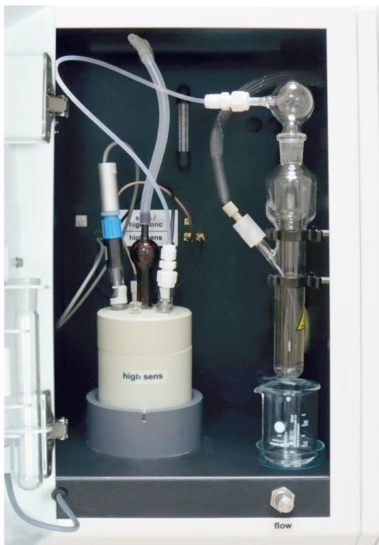
1. Установить высокочувствительную измерительную ячейку high sensitive с пальцем магнитной мешалки и крышкой в модуль хлора.
