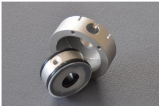
6. Извлечь пневматическое уплотнение из корпуса.
