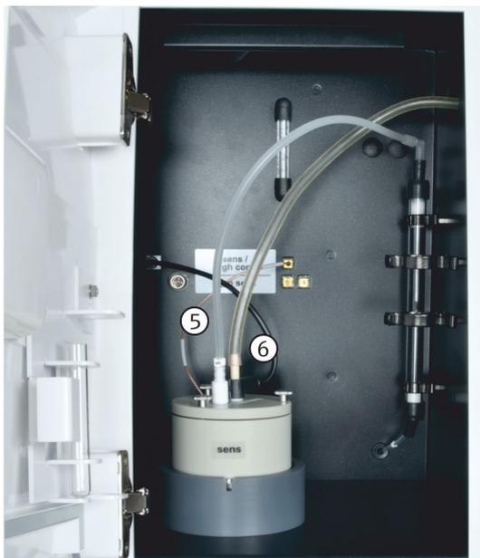
5. Подсоединить вывод газа измерительной ячейки (5) через всасывающий патрубок и трубку № 5 к верхнему концу адсорбирующей трубки.
