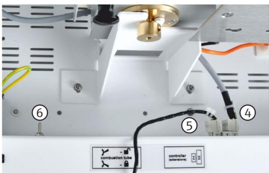
7. Вставить электрические соединения блока автоматической защиты (4) и линии переноса газа (5) в патрубку.
