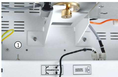
8. Закрыть пневматическое уплотнение блока автоматической защиты. Для этого переключить тумблер (1) вниз.
