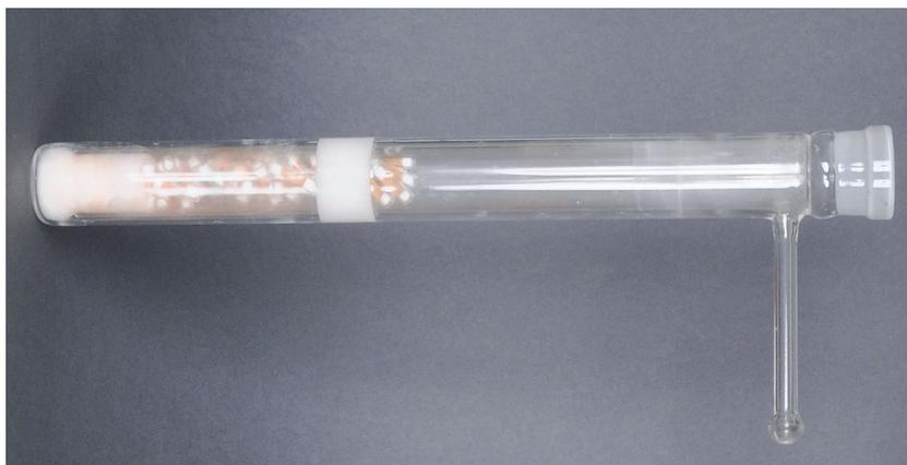
Изобр. 13 Трубка для сжигания, заполненная использованными кварцевыми контейнерами
