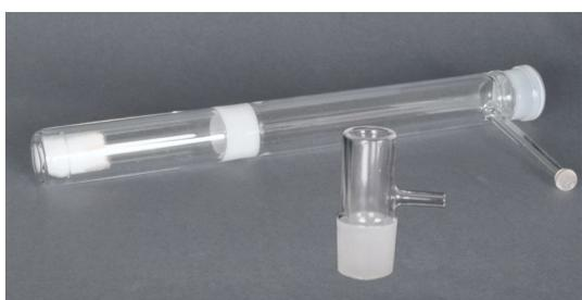
4. Осторожно задвинуть пробку из кварцевой ваты до нижней части в открытую трубку для сжигания.
