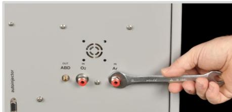
5. Открутить точки подключения газа рожковым гаечным ключом на 13 мм.
