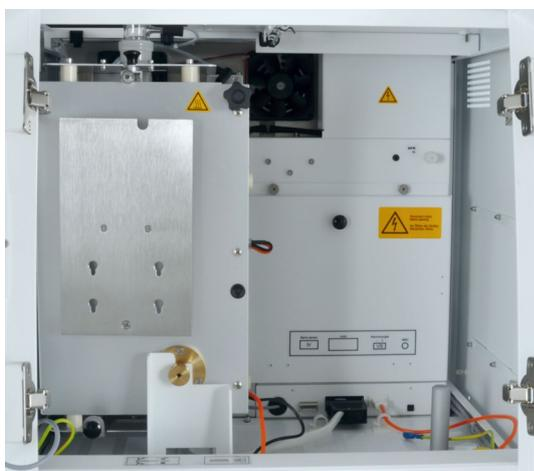
5. Перевести печь для сжигания в вертикальное положение, чтобы получить доступ к интерфейсам внутреннего пространства устройства.
