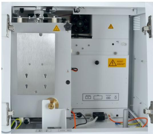
4. Перевести печь для сжигания в вертикальное положение, чтобы получить доступ к интерфейсам внутреннего пространства устройства.
