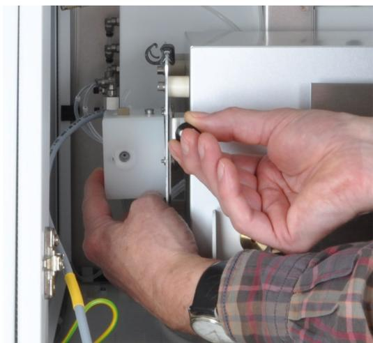
3. Удерживая левой рукой блок автоматической защиты, правой рукой потянуть на себя головку фиксирующего механизма, чтобы снять блокировку.
