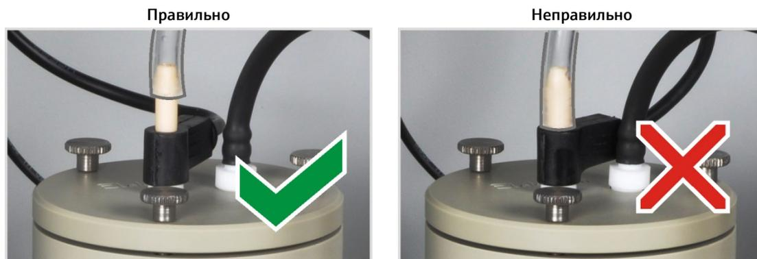
Наденьте гибкую трубку для анализируемого газа на электрод примерно на 1 см. Это обеспечит газонепроницаемость.
