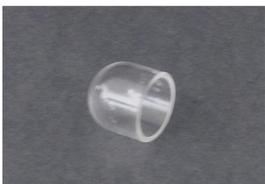
Пинцетом вставить кварцевый тигель в открытую трубку для сжигания.
