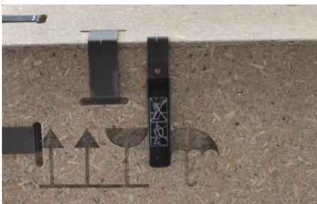
Das Werkzeug zum Entfernen der Klammern ist an die Transportkiste angeschraubt.
