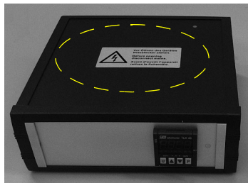
Abb. 87: Warnhinweis an der Steuerung
