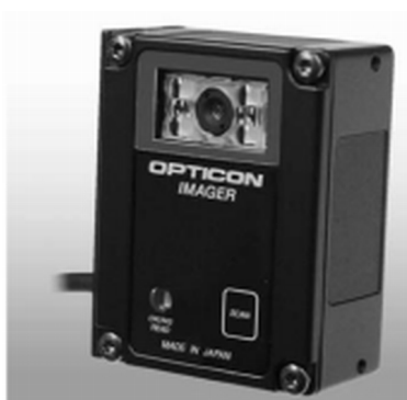
Fig. 114: Opticon NLV-2101 barcode reader
