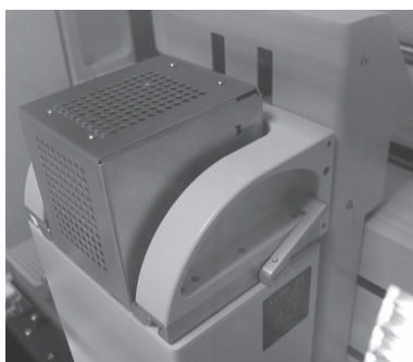
Fig. 21: Tête de pipetage prête au fonctionnement
