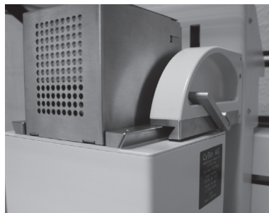
Fig. 23: Retirer la tête de pipetage
