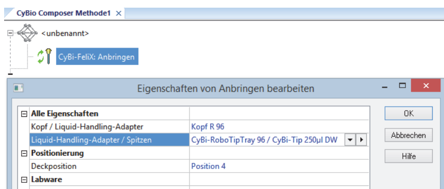
Fig. 36: Exemple : reprendre la tablette CyBio® RoboTipTray
