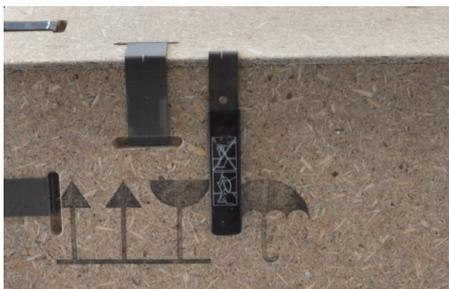
L'outil pour retirer les équerres de fixation est vissé sur la caisse de transport.
