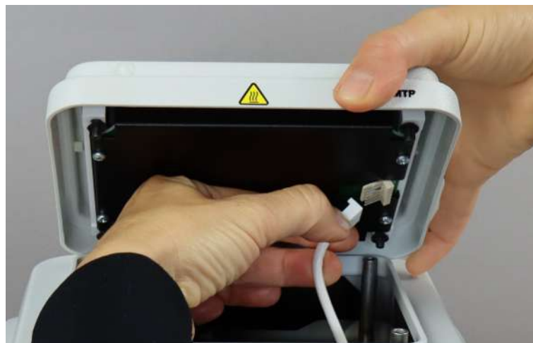
Abb. 8 Elektrischen Anschluss zwischen Grundgerät und Blockmodul herstellen
