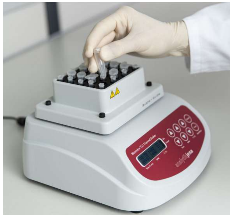
Abb. 5 Proben in Blockmodul einsetzen
