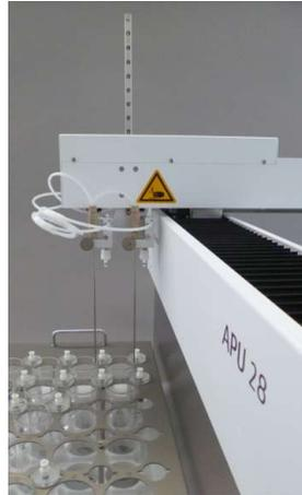
**Abb. 8 Zweikanalsystem APU 28/1 S mit 2 Dosierköpfen und Kanülen**
