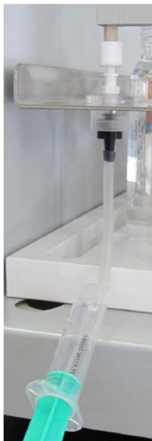
**Abb. 39 Entlüftungskit an Position 1**
