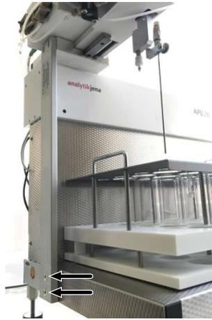
**Abb. 15 Transportsicherung entfernen**
