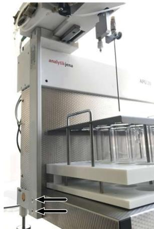
**Fig. 15 Retirada de los elementos de protección para el transporte**
