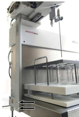
Fig. 42 Fijar el elemento de protección para el transporte
