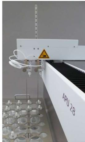
**Fig. 8** Sistema de dos canales APU 28/1 S con 2 cabezales de dosificación y cánulas
