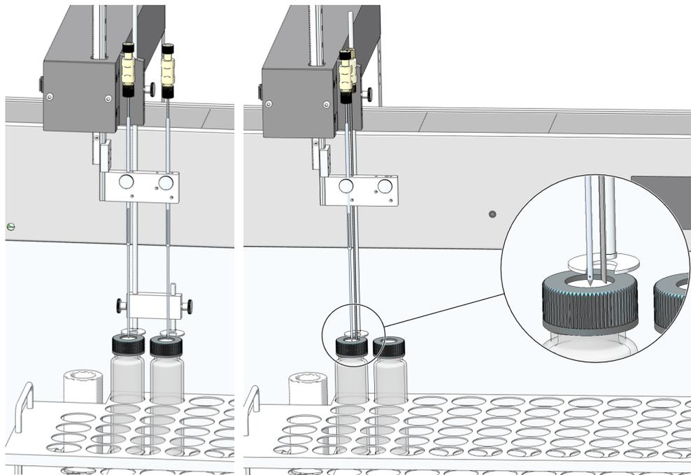
**Fig. 41 Posición de la cánula para las mediciones de NPOC con soplado paralelo (izquierda) y no paralelo (derecha)**
