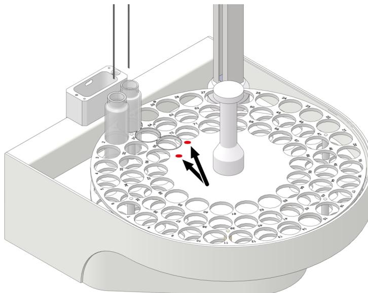
**Fig. 46 Puntos de ajuste en la bandeja de muestras**
