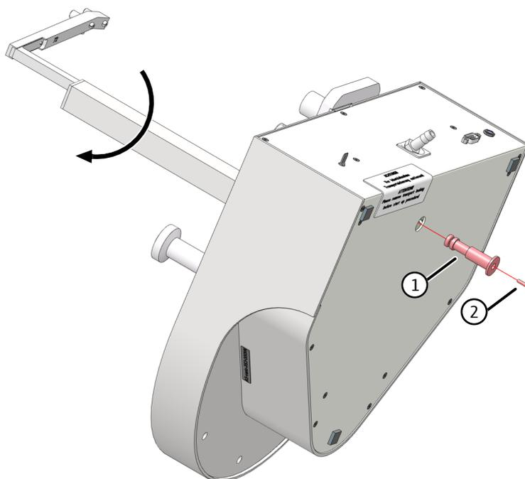
**Fig. 58 Asegurar el automuestreador para el transporte**
