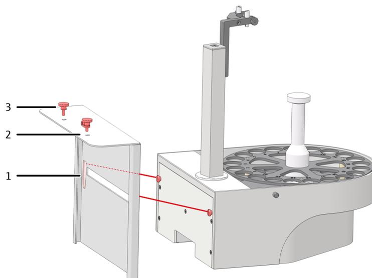
**Fig. 27 Fijar el automuestreador AS 21hp al soporte**
