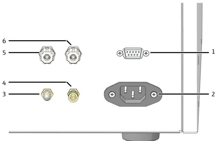
**Fig. 45 Conexiones en el panel trasero del módulo de materia sólida**
