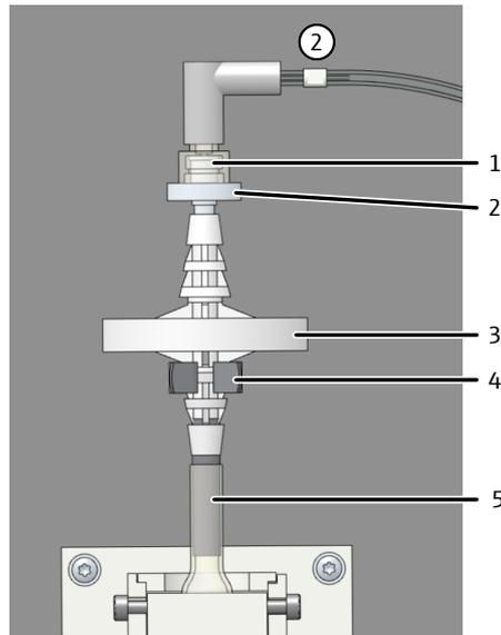
**Fig. 54 Sustituir la trampa de agua de la parte frontal**
