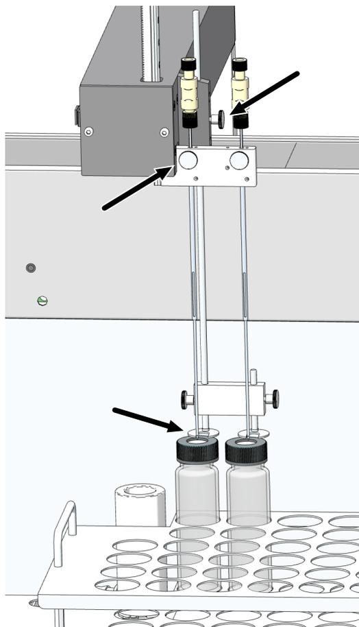
**Fig. 48 Instalar cánulas (aquí: 2 cánulas para el soplado paralelo)**
