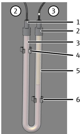
**Fig. 56** Sustitución de la trampa de halógenos
