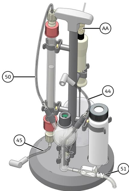
Después de conectar el módulo POC para el funcionamiento manual, el gas portador fluye continuamente por el reactor POC en el tubo de combustión del analizador.
