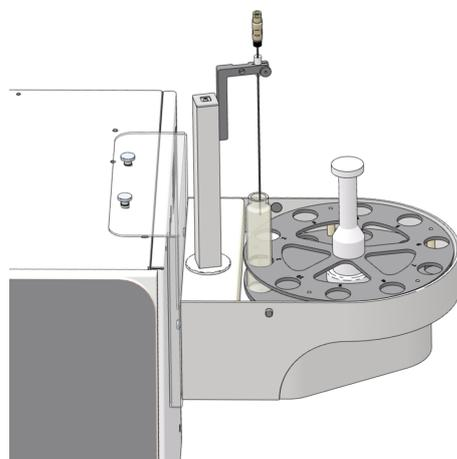
**Fig. 25 Automuestreador unido al analizador mediante un soporte**
