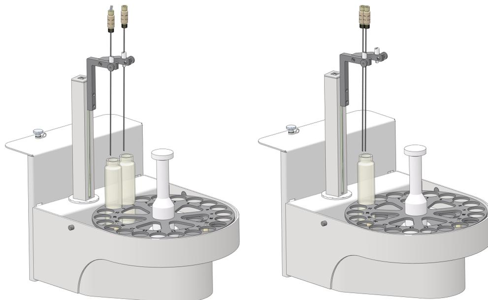
**Fig. 24 Soplado paralelo (izquierda) y secuencial (derecha)**
