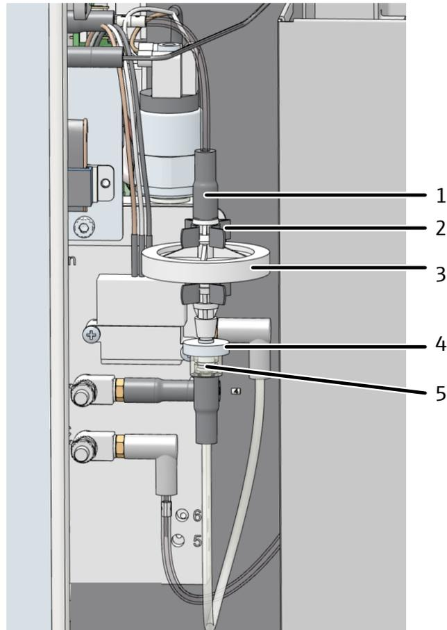
**Fig. 55 Sustituir las trampas de agua de la caja de gas**
