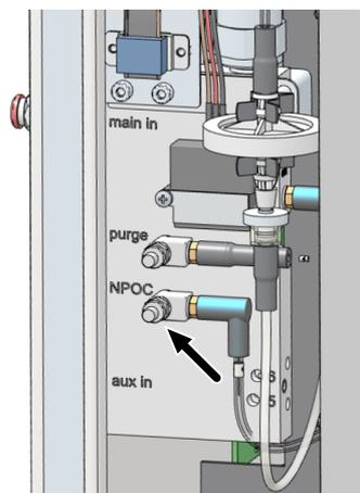
Fig. 5 Ajuste del flujo de purga NPOC
