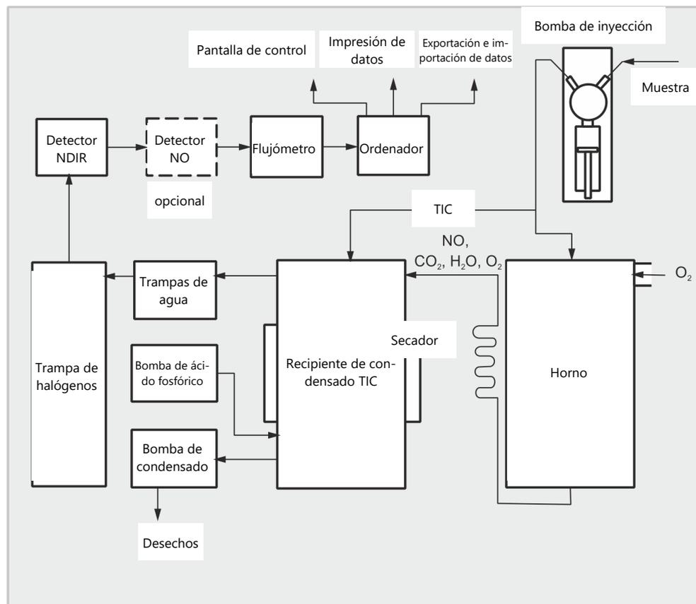
**Fig. 18 Principio de funcionamiento**
