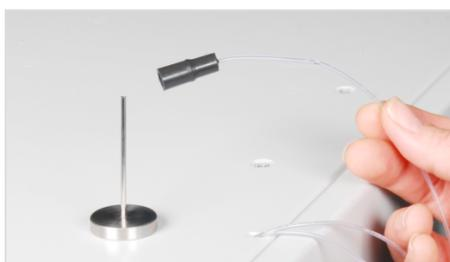
▶ Deslice el conector FAST de la cánula en la manguera.
