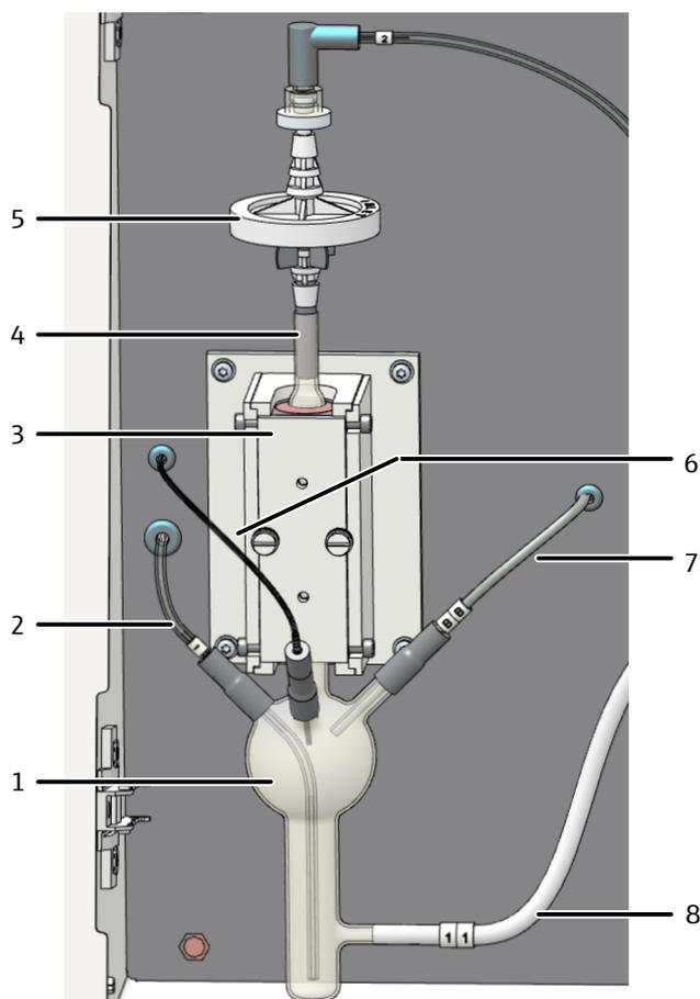
**Fig. 12 Módulo de condensación de TIC**
