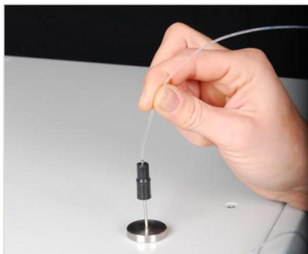
▶ Inserte la manguera en la cánula del dispositivo auxiliar de inserción.
