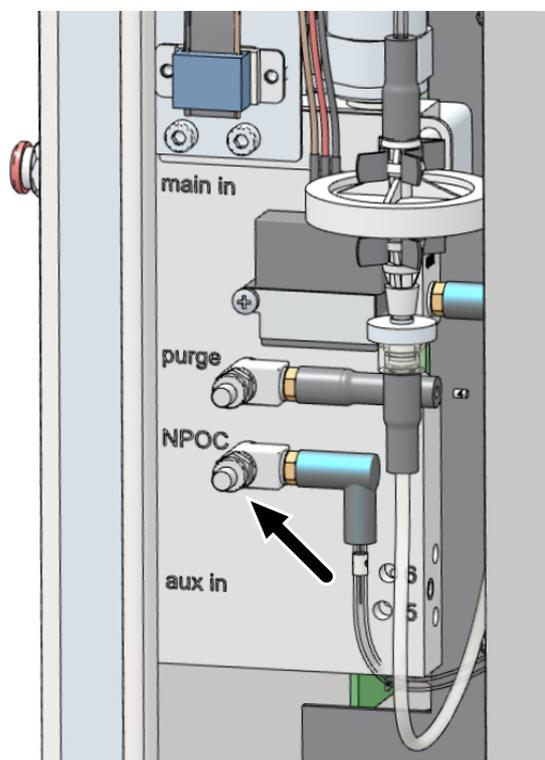
Fig. 51 Ajuste del flujo de purga NPOC
