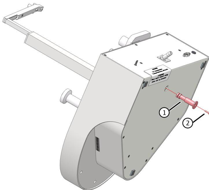
**Fig. 32 Protección para el transporte**
