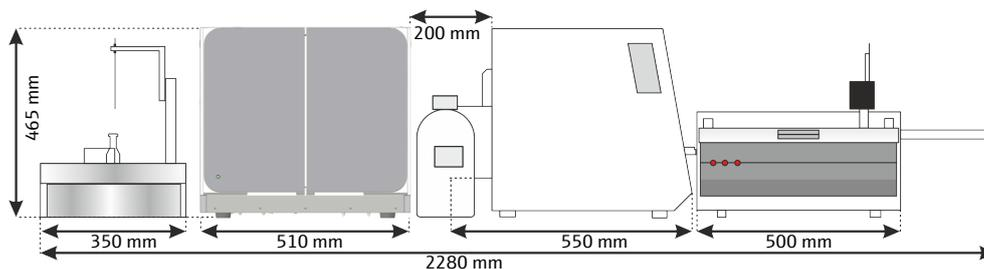
Fig. 20 Necesidad de espacio del sistema de medición modular multi N/C 3300 duo
