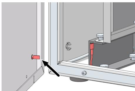
**Fig. 50 Conexión a tierra de protección en la pared lateral**
