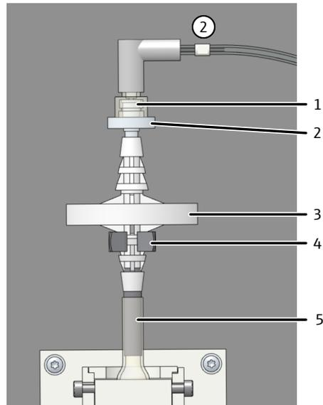
**Fig. 54 Remplacer les pièges à eau sur la face avant**
