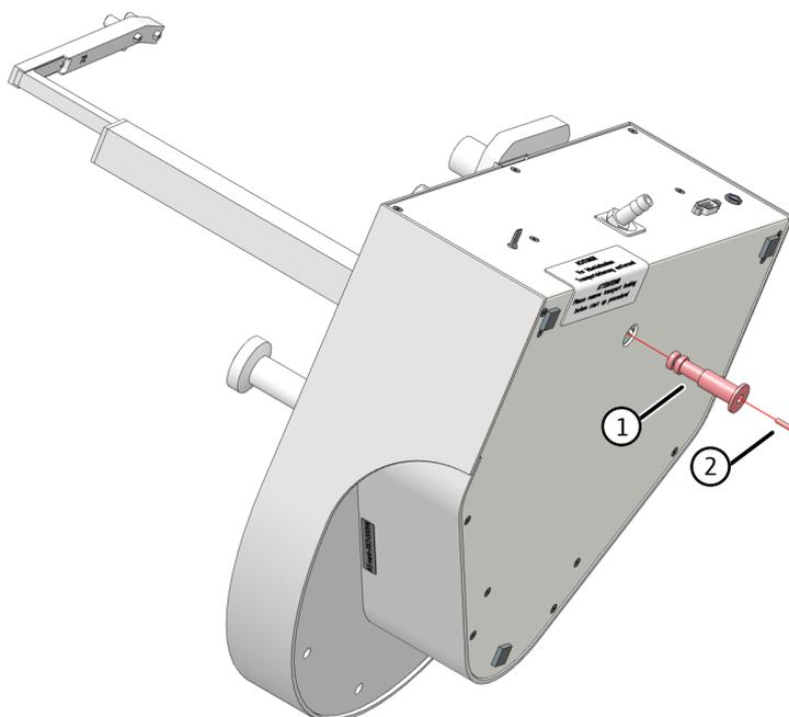
**Fig. 32 Dispositif de sécurité du transport**
