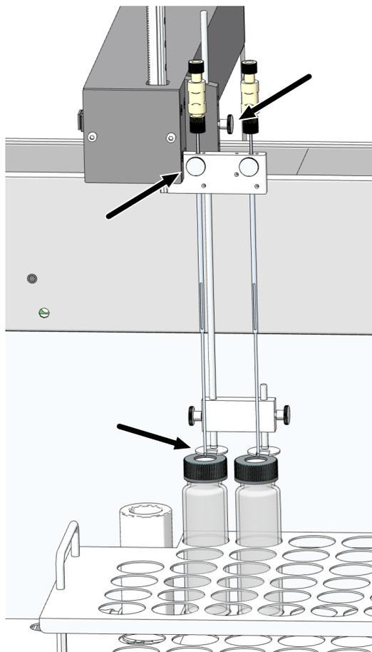
**Fig. 48 Installer les canules (ici : 2 canules pour l'éjection parallèle)**
