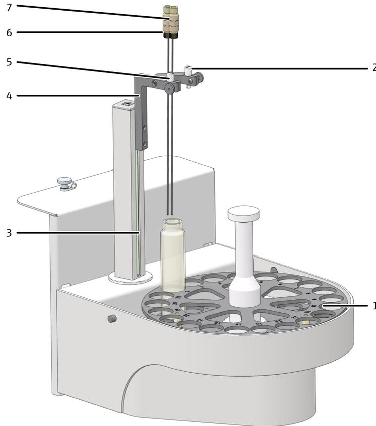
**Fig. 23 Distributeur d'échantillons AS 21hp**
