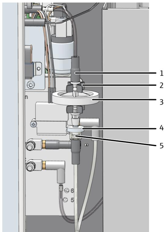
**Fig. 55 Remplacer les pièges à eau sur la boîte à gaz**
