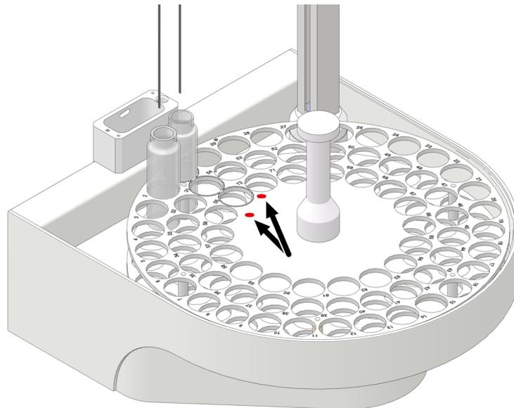
**Fig. 46 Points d'ajustage sur le porte-échantillons**
