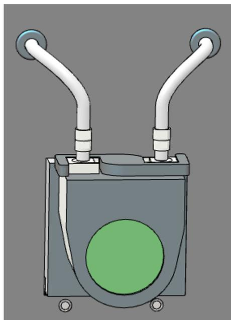
**Fig. 6 Pompe de condensat**
