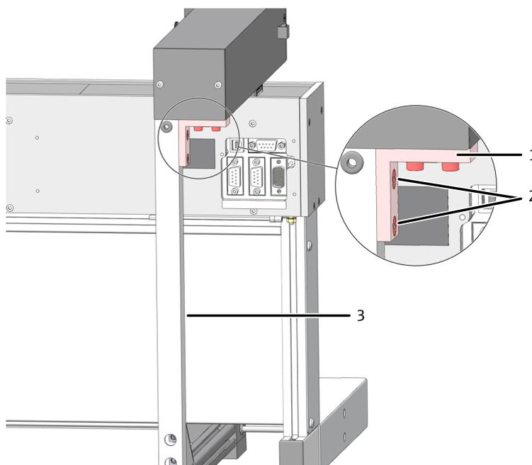
**Fig. 40 Monter l'étrier d'agitation**
