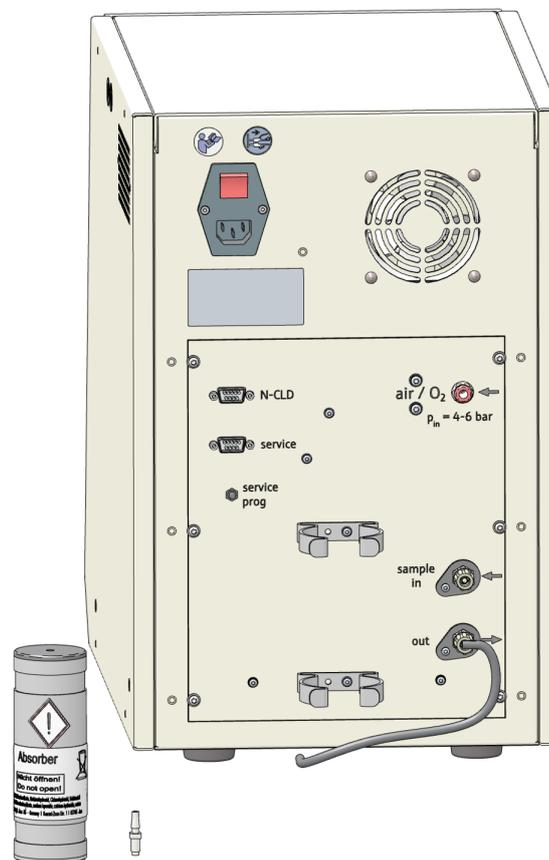
**Fig. 57 Remplacement de la cartouche de l'adsorbant**
