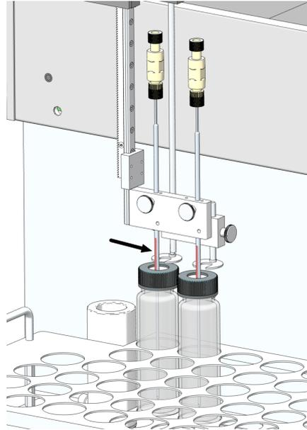
**Fig. 49 Ajuster la position 1**
