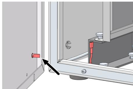
**Fig. 50 Conducteur de protection sur la paroi latérale**
