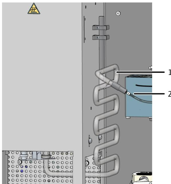
**Fig. 11 Serpentin de condensation**
