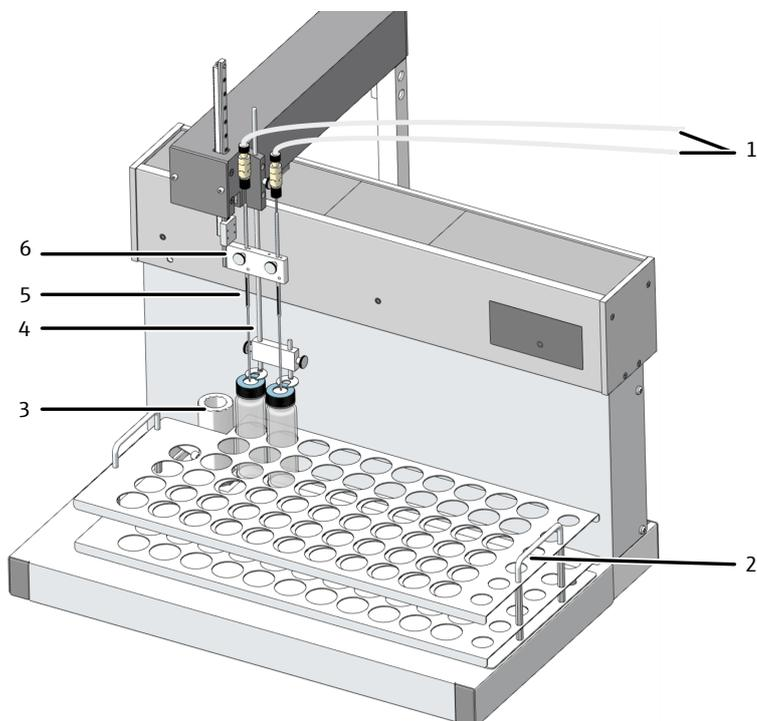
**Fig. 36** Distributeur d'échantillons EPA Sampler
