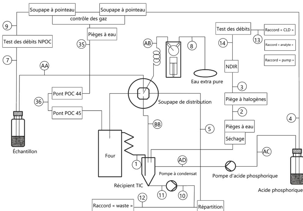
Fig. 4 Plan de la tuyauterie
