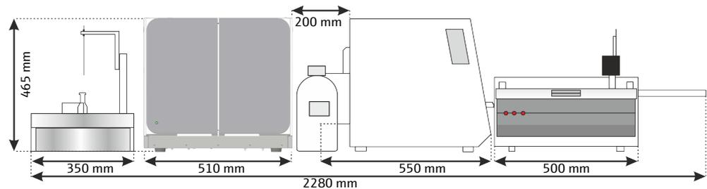
Fig. 20 Encombrement du système de mesure modulaire multi N/C 3300 duo
