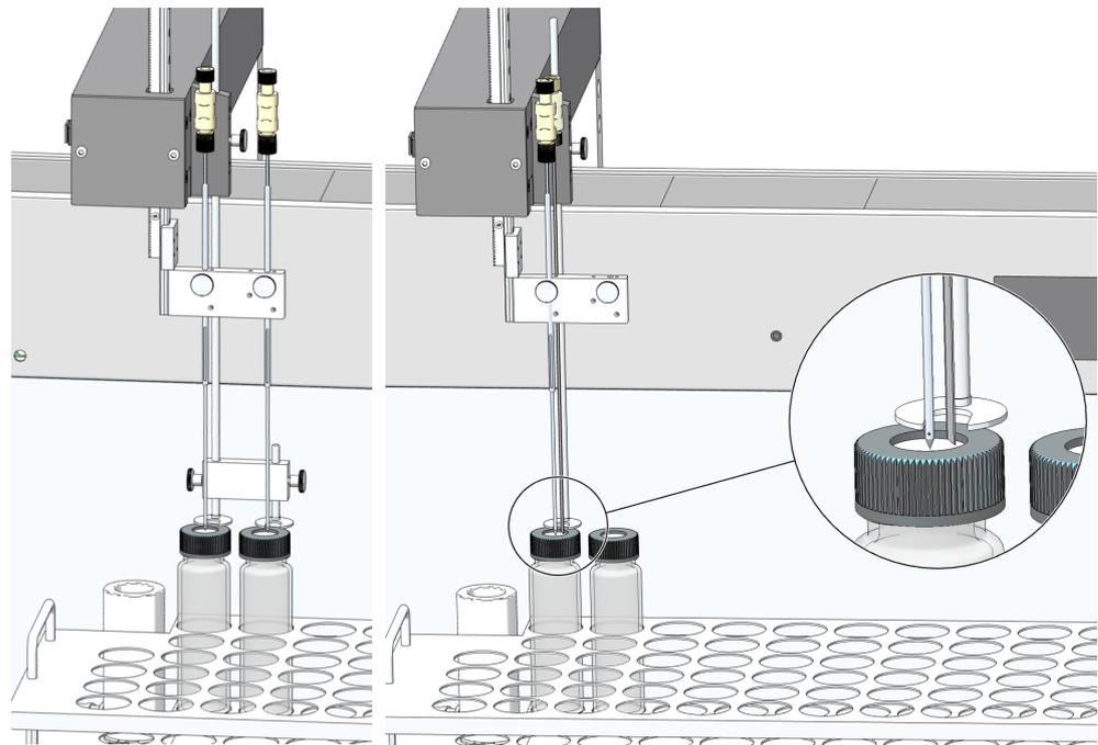
**Fig. 4.1** Position de la canule pour les mesures NPOC avec soufflage parallèle (gauche) et non parallèle (droite)
