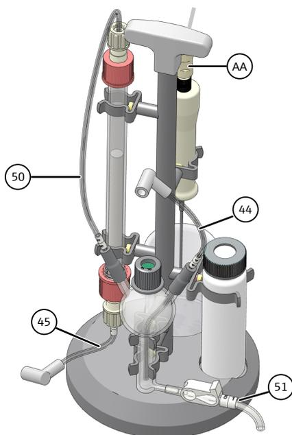
Une fois le module POC pour le mode manuel connecté, le gaz porteur passe en continu à travers le réacteur POC dans le tube de combustion dans l'analyseur.
