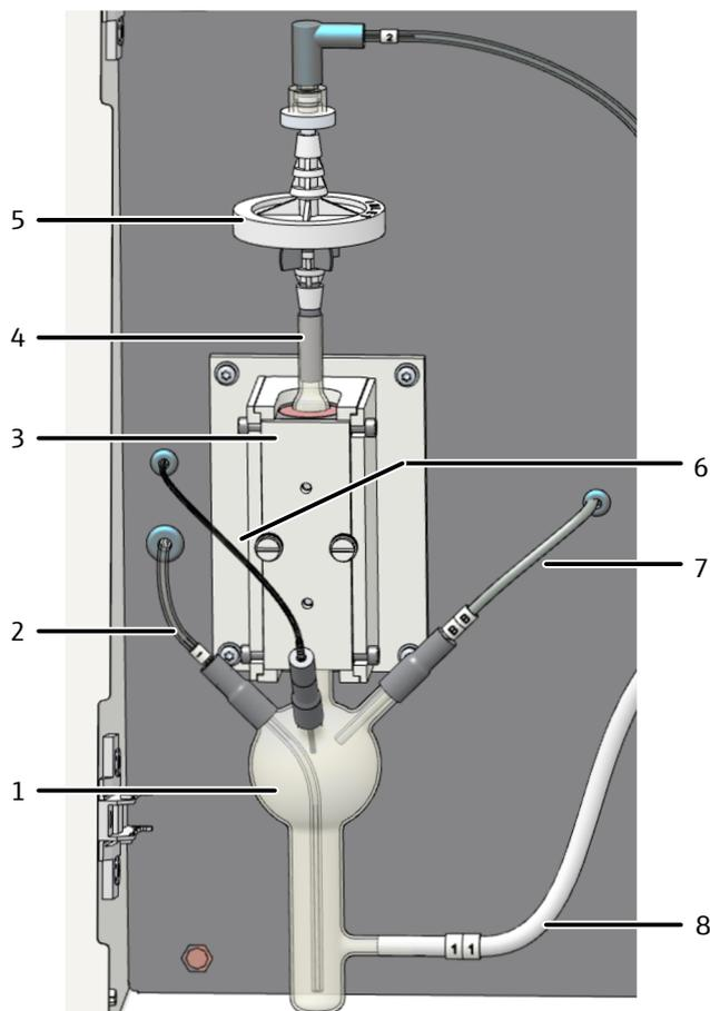
**Fig. 12** Module de condensat TIC
