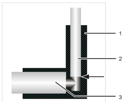
**Fig. 52** Connecteur FAST, coudé
