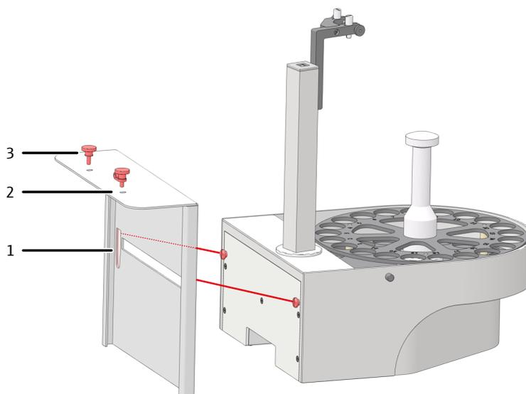
**Fig. 27 Fixer le distributeur d'échantillons AS 21hp sur le support**
