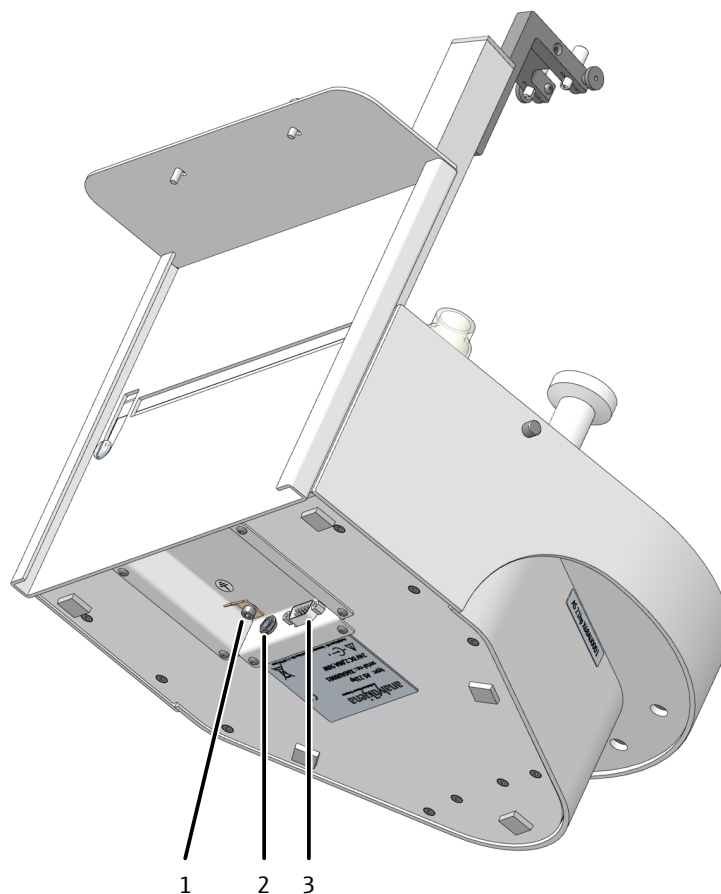
Rys. 25 Złącza na spodzie autosamplera
