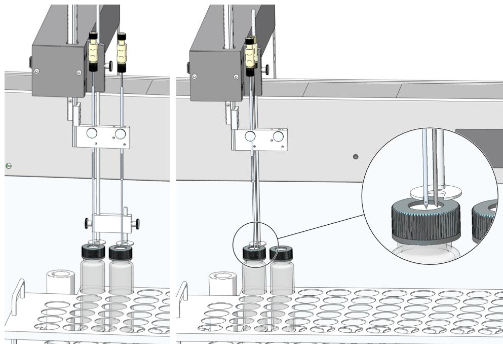
그림 41 병렬(왼쪽) 및 비병렬(오른쪽) 퍼징을 사용한 NPOC 측정을 위한 캐뉼라 위치.
