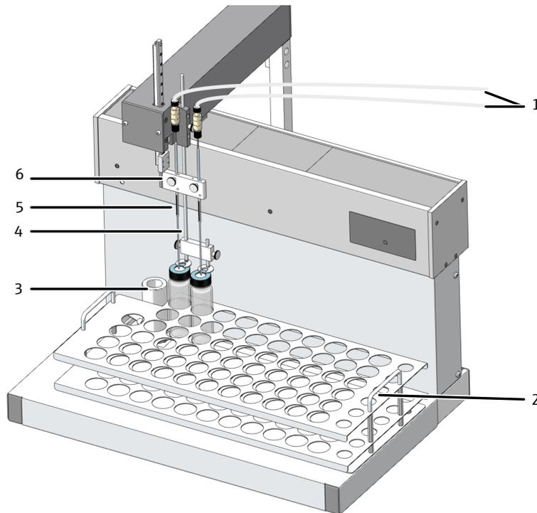
그림 36 EPA Sampler 자동 샘플러
