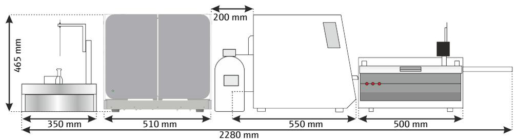
그림 20 모듈형 측정 시스템 multi N/C 3300 duo에 필요한 공간
