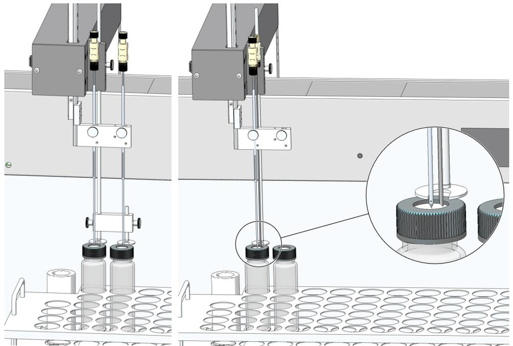
그림 41 병렬(왼쪽) 및 비병렬(오른쪽) 퍼징을 사용한 NPOC 측정을 위한 캐놀라 위치.
